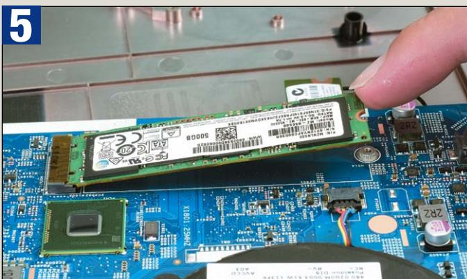
**5** Die Samsung-SSD stecken Sie in den freien m.2-Slot, drücken Sie sie leicht nach unten und fixieren Sie sie mit der zuvor entfernten Schraube. Ziehen Sie vorsichtig die Schutzfolie von den Speicherbänken. (Bild 6) Drücken Sie die ...
