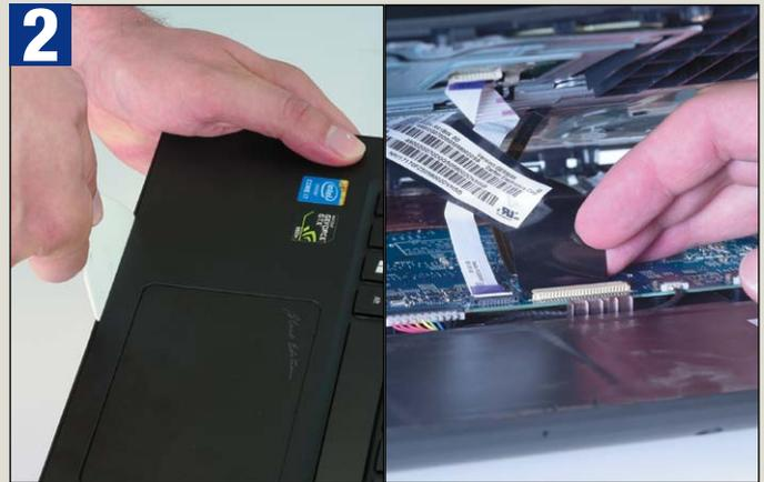
**2** Drücken Sie mit einem Kunststoffspatel in den umlaufenden Spalt, und hebeln Sie die Abdeckung heraus. Achten Sie beim Anheben der Tastatur auf die drei Flachbandkabel. Öffnen Sie deren Arretierung, und ziehen Sie die Kabel ab.
