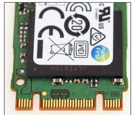
**Der m.2-Slot ist klein und dank PCIe die beste Anbindung für eine SSD.**
