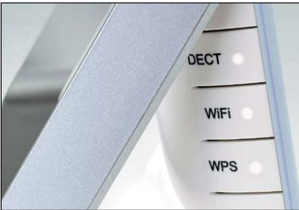
WLAN ein-/ausschalten, DECT-Telefon und WLAN-Client einbinden klappt per Taste direkt am Gerät.
