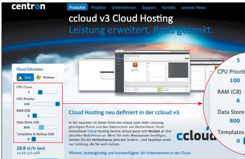
Beispiel Centron: Über Schieberegler lassen sich Instanzen leicht konfigurieren, etwa Anzahl virtueller CPU-Kerne und benötigter Speicherplatz.
