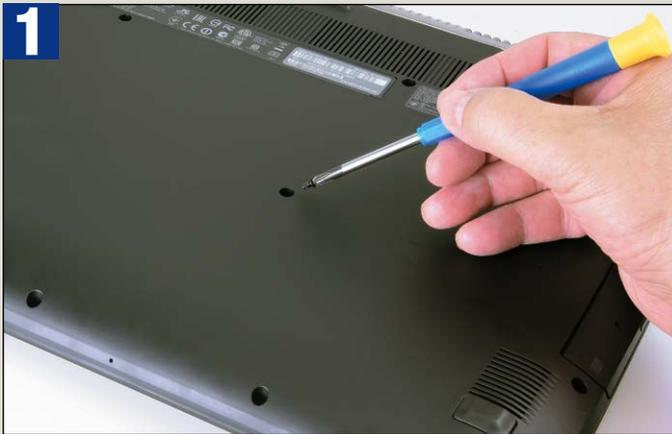
**1** Lösen Sie auf der Notebook-Unterseite alle Schrauben und die silberfarbene Abdeckschiene am hinteren Gehäuserand. Drehen Sie das Notebook dann wieder so um, dass Sie auf die Tastatur sehen.
