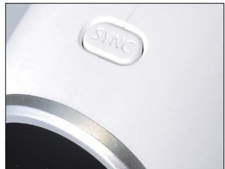
Mit dem Sync-Knopf an der Kamera lässt sich die Verbindung zur Basisstation herstellen.
