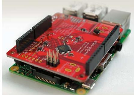
**Watterotts Shields sind eine günstige, leicht einzurichtende Erweiterung, um den Raspberry Pi und Arduino Yún anzusprechen.**
