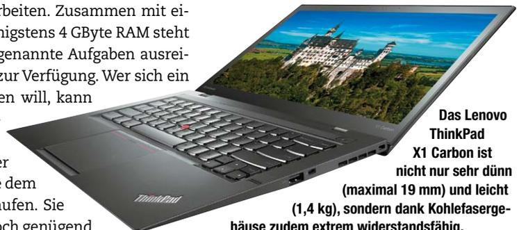
Das Lenovo ThinkPad X1 Carbon ist nicht nur sehr dünn (maximal 19 mm) und leicht (1,4 kg), sondern dank Kohlefasergehäuse zudem extrem widerstandsfähig.
