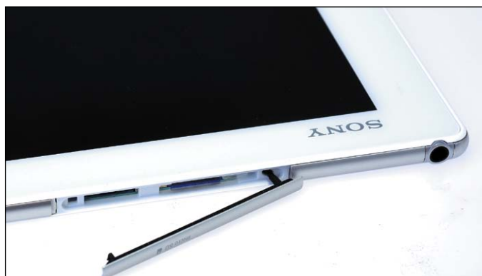
Wasserdicht geschützt sind SIM- und SD-Kartenanschluss beim Sony Xperia Z4.
