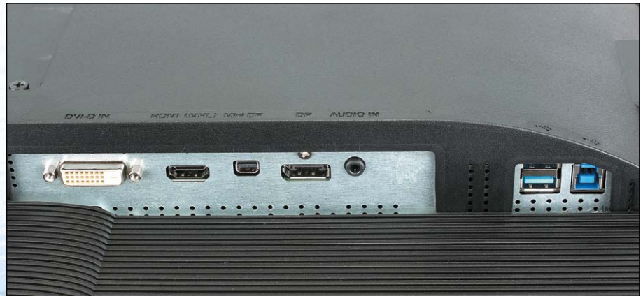
Acers B286HK besitzt die Bildanschlüsse DVI, HDMI, Mini-DisplayPort und DisplayPort (v.l.).
