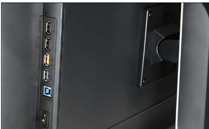
Das schnelle Laden externer Geräte ermöglicht der mit gelber Farbe gekennzeichnete USB-Port des Philips.
