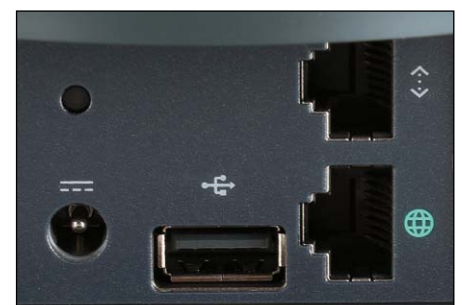
Der OnHub besitzt einen WAN- und nur einen GBit-LAN-Port sowie einen nicht aktivierten USB-3.0-Port.
