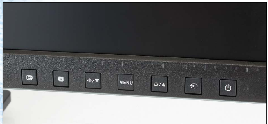
Die mechanischen Tasten für das OSD verfügen beim Asus PB298Q über sehr gute Druckpunkte.
