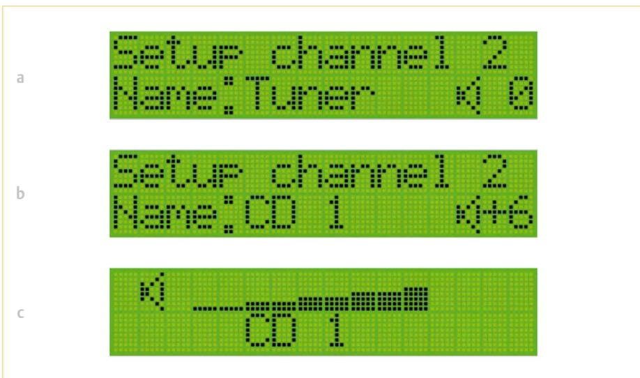
Bild 4. Display-Anzeigen: Signalquellen-Name eingeben (a), Lautstärke-Voreinstellung festlegen (b), grafische Anzeige der Lautstärke (c).
