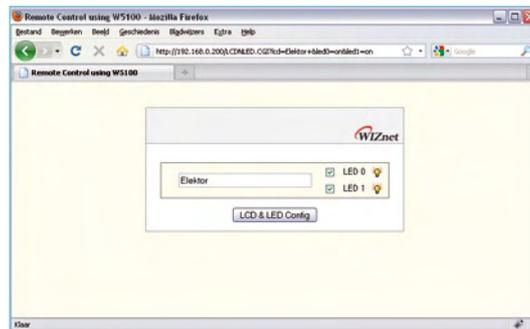
Bild 5. Mit dem Beispiel-Webserver kann man die LEDs auf dem Applicationboard übers Internet steuern. In die Textbox eingegebene Texte werden auf dem OLED dargestellt!
