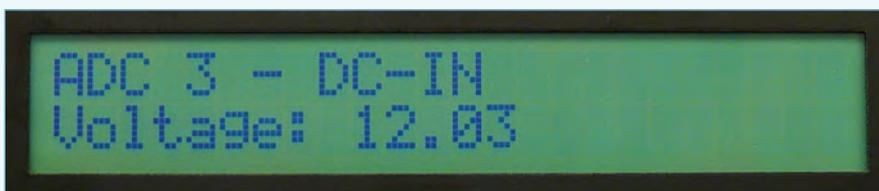
Bild 8. Kanal 3 misst die Spannung am Versorgungsspannungsanschluss der Schaltung (nominal 12 V).
