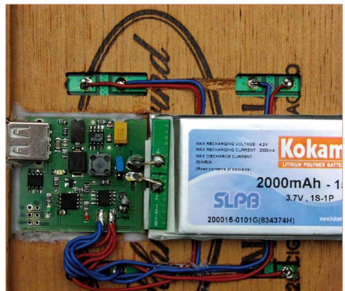
Bild 8. Innenansicht des ersten Prototyps. Die Platine ist hier direkt mit den vier Solarmodulen verbunden.
