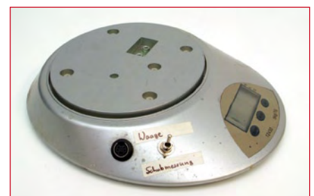
Bild 5. Mit Hilfe des Umschalters kann die Waage weiterhin zum Wiegen verwendet werden.
