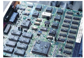
Bild 7. Eine neue Beschichtung schützt Schaltungen gegen feuchte Witterung (Foto: 3M).
