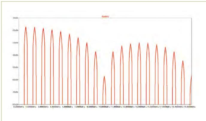
Bild 9. Spektrum der Rechteckwelle von Bild 8 mit einer Grundfrequenz von 1 MHz und der ersten Nullstelle bei 10 MHz.
