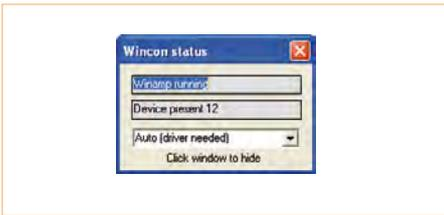
Bild 3. Das Visual-Basic-Programm Wincon verbindet die externe Hardware über USB mit der Winamp-API.
