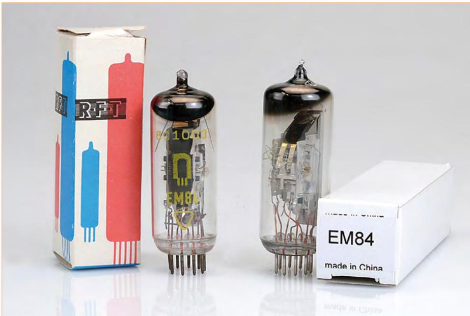
Bild 3. Die Röhre EM84 aus deutscher (RFT) und aus chinesischer Fertigung.
