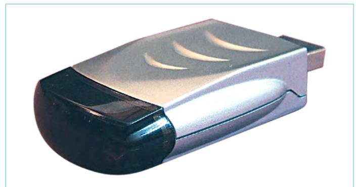
Bild 8. IrDA-USB-Schnittstellenwandler eines unbekanntes Herstellers. (Quelle: Wikipedia)
