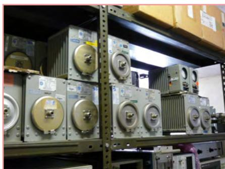
Entdeckung 2: Eine Sammlung von Dummy-Loads für HF-Wattmeter von Bird, dem Marktführer in diesem Segment.
