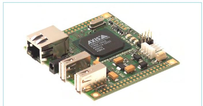
Bild 9. Das Board FOX LX832 von Acme Systems ist 66 x 72 mm groß. Darauf befinden sich ein Ethernet-Port, zwei USB-1.1-Ports, ein I2C-Port, andere serielle und parallele Ports sowie diverse digitale Ein- und Ausgänge. Es läuft unter Linux und kostet 139 €.
