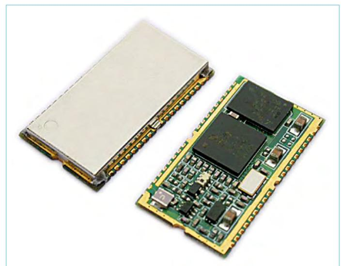
Bild 3. Das Modul BTM222 von Rayson hat die Maße 28 · 15 mm und stellt eine drahtlose serielle Verbindung über Bluetooth her.
