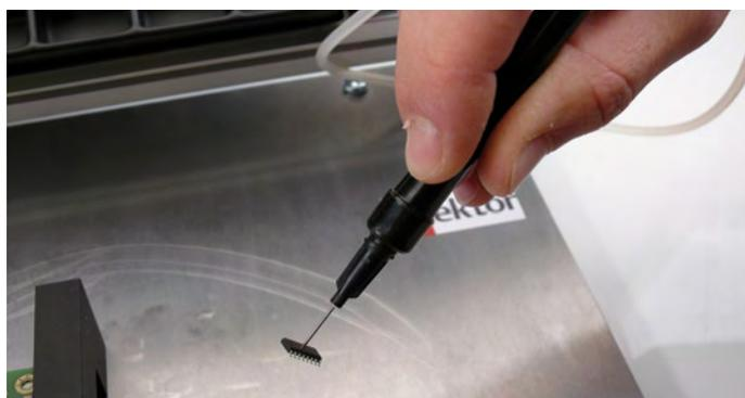
Um nun ein Bauteil zu erfassen, hält man die Spitze der Nadel gegen eine Bauteil-Oberfläche und erzeugt Unterdruck, indem man mit dem Finger das seitliche Loch am Halter schließt.
