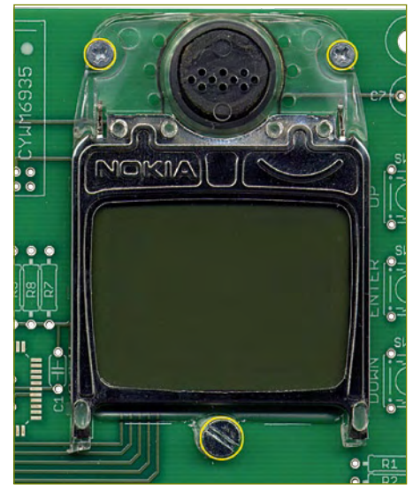
Bild 6. Das Display wird mit zwei M2-Schrauben und einer M3-Schraube auf der Platine befestigt.
