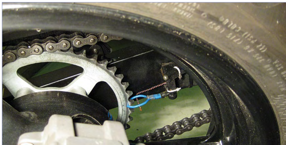
Bild 5. Das Öl gelangt nicht direkt auf die Kette, sondern auf das Ritzel, von wo es sich besser und sparsamer auf der Kette verteilt.
