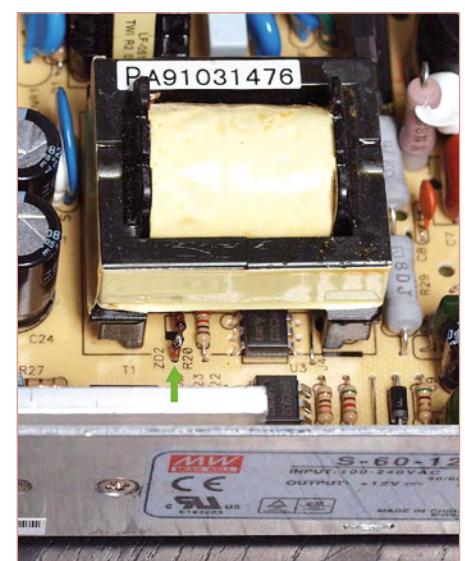
Bild 4. Unter dem Trafo steckt ein Überspannungsschutz aus Z-Diode und Optokoppler. Eine zusätzliche Silizium-Diode in Serie mit der Z-Diode erhöht die maximale Ausgangsspannung um 0,7 V.
