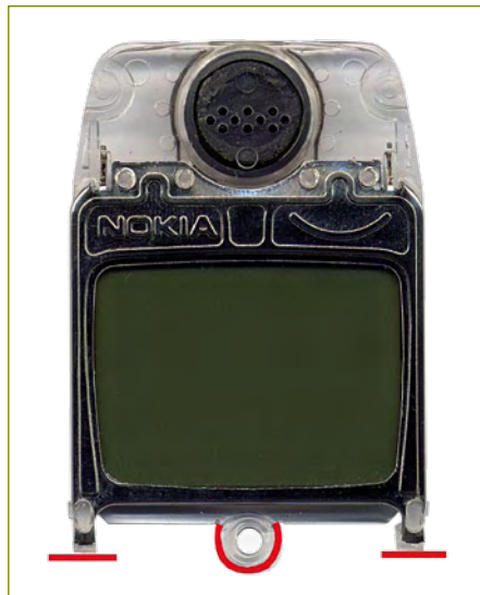
Bild 5. Die Trägerplatte muss entlang der roten Markierungen durchtrennt werden.
