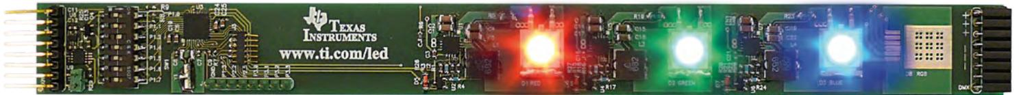
C4 und C5 entsprechend der höheren Ausgangsspannung auch eine höhere Spannungsfestigkeit aufweisen. Die Stromquellschaltung ist mit U1, U5 und U7 in dreifacher Ausführung und identischer Dimensionierung aufgebaut, um eine rote, grüne und blaue Hochleistungs-LED ansteuern zu können.
