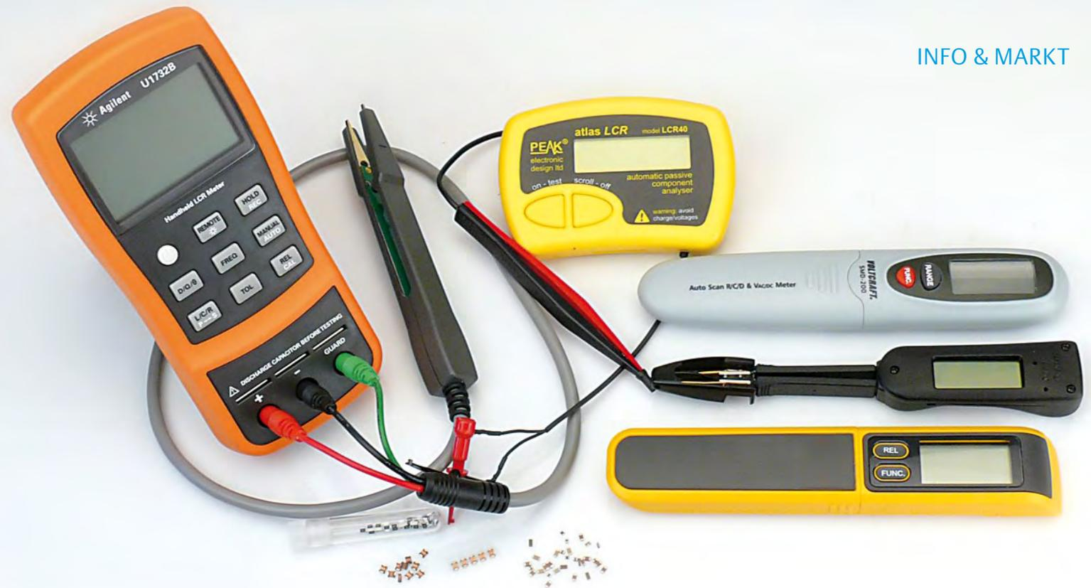
räte konventioneller Bauform. Das Modell Atlas LCR40 von Peak ist ein kleines, intelligentes LCR-Meter (Preis unter 100 €), für das ein Kabel mit Messspitze als optionales Zubehör lieferbar ist. Agilent hat das RLC-Meter U1732B im Angebot, das rund 340 € kostet. Für dieses in konventioneller Bauart gehaltene Messgerät ist ebenfalls ein spezielles Kabel mit Messspitze erhältlich.
