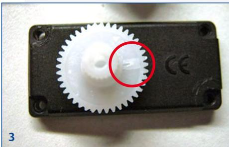
Prüfen Sie vor dem Zusammenbau, ob der modifizierte Servo tatsächlich im Vollkreis drehen kann. Auch nach dem Zusammenbau sollten Sie sich noch einmal vergewissern, dass der Servo tatsächlich um 360° dreht.
