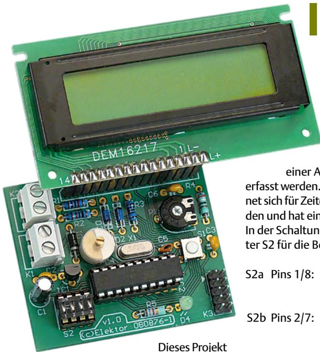
Dieses Projekt zeigt, wie wenig Hardware heute nötig ist, um die Dauer von Impulsen und andere interessante technische Zeiten präzise zu messen und auf einem LCD anzuzeigen. Im Prinzip reicht schon ein AVR-Mikrocontroller vom Typ ATtiny2313 aus, um die Zeit zwischen zwei Impulsflanken an den Eingängen PD2 (Pin 6) und PD3 (Pin 7) zu erfassen. Es können Zeiten im Bereich von
