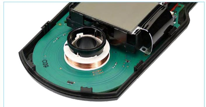
Bild 2. Bei den Leitungssuchern von Bosch und Skil wird eine zur Wand gerichtete Spule verwendet, um Metall präziser aufspüren zu können. Die Leiterbahnen drumherum bilden den kapazitiven Sensor für die Holzdetektion.
