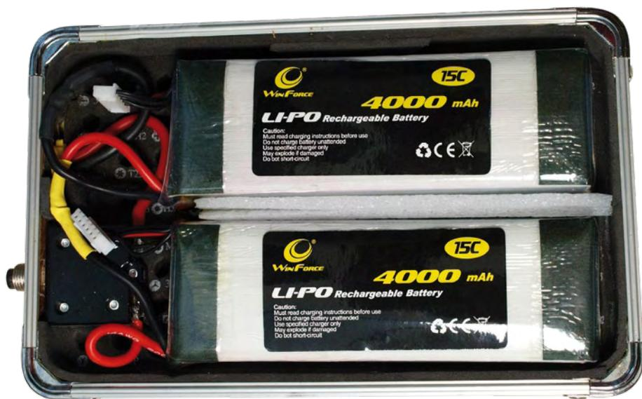
Bild 1. Zwei chinesische 5s-LiPos in Serie. Zusammen mit einer Thermosicherung eingebaut in ein kleines Alu-Gehäuse dienen sie als Energiequelle eines Elektro-Fahrrads.
