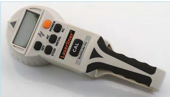
Metall, Spannung, Empfindlichkeit und Kalibrierung. Nach einigen Minuten im Ruhezustand schaltet er automatisch ab. Das Display zeigt deutlich an, welche Aktionen auszuführen sind. So erhält man beispielsweise die Meldung, dass man den Scanner an eine Wand halten und dann auf die Cal-Taste drücken muss. Bei der Feststellung von Spannung leuchtet eine separate Spannungs-LED auf. Es gibt drei Empfindlichkeitsstufen, die man manuell selektieren kann. Ein Summer ist natürlich auch vorhanden.
