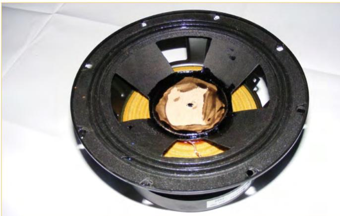
Bild 4. Mit diesem Selbstbau-Rütteltisch kann man elektronische Bauteile testen.
