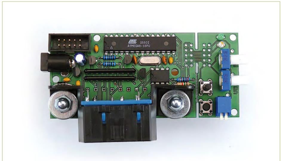
Bild 3. Bestückte Musterplatine mit horizontal montierter OBD-Buchse und seitlich einzustellenden DIP-Switches.
