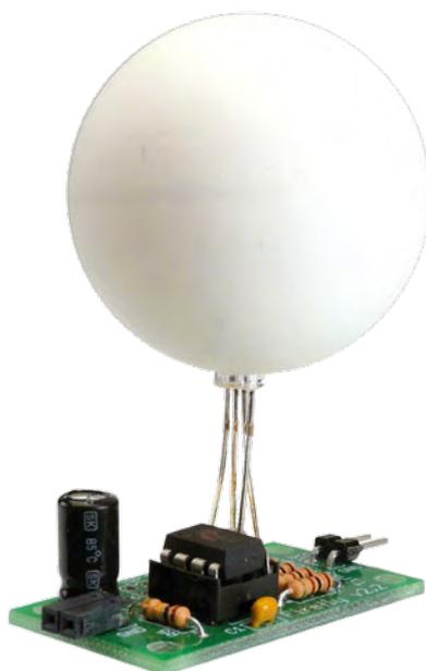
jedem LDR überlegen ist, da Ersterer sehr viel schneller auf Helligkeitsschwankungen reagiert (rund 5 ms gegenüber etwa 50 ms). Ein weiteres Kriterium für den optischen Sensor ist, dass er halbwegs den spektralen Bereich des menschlichen Auges abdeckt (ca. 400 nm bis ca. 700 nm).
