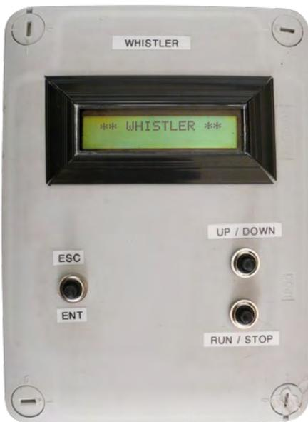
Der akustische Trainer produziert in festem Rhythmus oder in unregelmäßigen Zeitabständen akustische Signale, die beim Timing eines sportlichen Trainings helfen. Ein Zeitintervall beginnt mit einem kurzen Ton, das Intervallende wird von zwei kurzen Tönen signalisiert. In den Einstellungen 1 bis 4 wird eine bestimmte Zyklen-Anzahl durchlaufen, jeder
