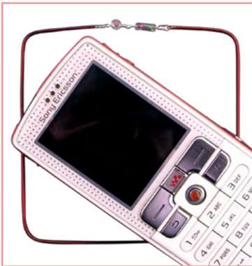
mit 0,7 V Flussspannung und höherer Kapazität nur sehr eingeschränkt verwendbar, auch Schottky-Dioden wie BAT85 (0,4 V) sind nicht optimal.
