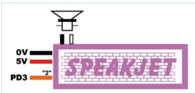
Bild 9. Der Speakjet-Anschluss ans ATM18-Board. Beachten Sie, dass sich Pin „2“ gleich neben Pin „TX“ befindet.
