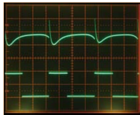
Bild 3. Das Signal hinter dem Differenzverstärker (oben) und das Tachosignal am Ausgang der Schaltung (unten).
