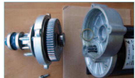
Bild 8. Nach dem Lösen der vier Schrauben des Getriebedeckels lässt sich der Deckel samt Getriebewelle und Zahnrad vom Motor abziehen.
