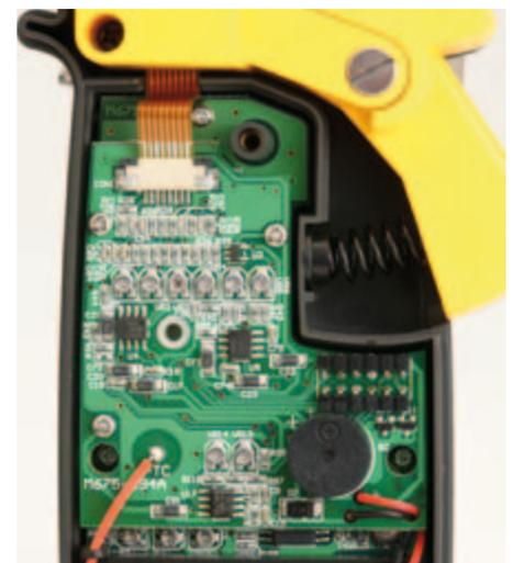
Bild 4. Strommesszangen sind komplexe Messsysteme mit vielen Abgleichpunkten. In diesem Modell haben wir 15 Trimpotis gezählt!
