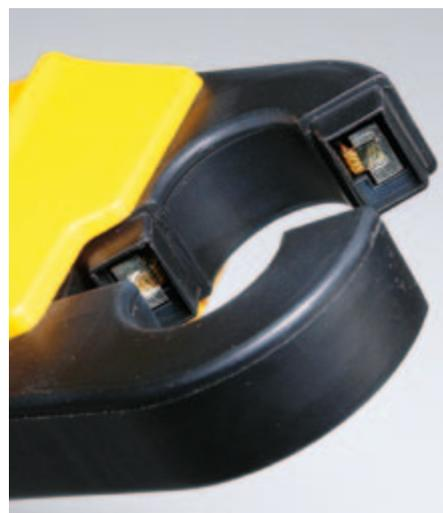
Bild 2. Die Hall-Sensoren befinden sich in den Luftspalten des Jochs. Bei dieser Messzange von Fluke sind sie deutlich zu erkennen.
