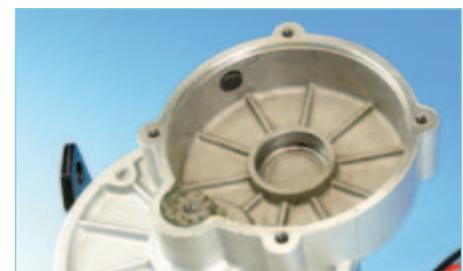
Bild 9. Die richtige Lochposition für die Montage des Geartooth-Sensors beim Elektor-Wheelie.
