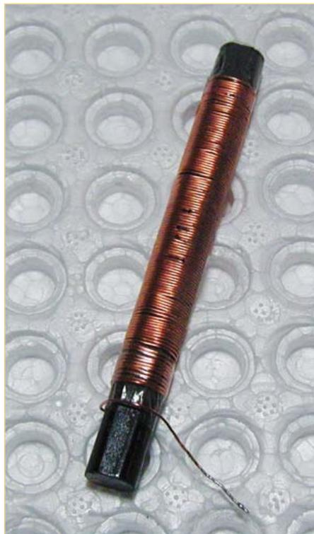
Bild 5. Eine einstellbare Spule mit Ferrit-Kern dient zur Einstellung einer Serienresonanz bei 40 kHz mit den kapazitiven Schallwandlern. Diese Maßnahme erlaubt niedrige Betriebsspannungen.
