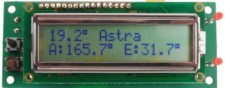
Wer regelmäßig eine Satellitenschüssel neu ausrichten muss (zum Beispiel, wenn ein Camper oder ein Boot damit ausgestattet ist), steht immer vor dem Problem, die jeweilige Satellitenposition zu ermitteln. Der GPS-basierte SATFINDER verfügt über eine Datenbank mit den beliebtesten TV-Satelliten und berechnet mit Hilfe der GPS-Standortdaten alles, was man zum Ausrichten der Antenne auf den Satelliten braucht.
