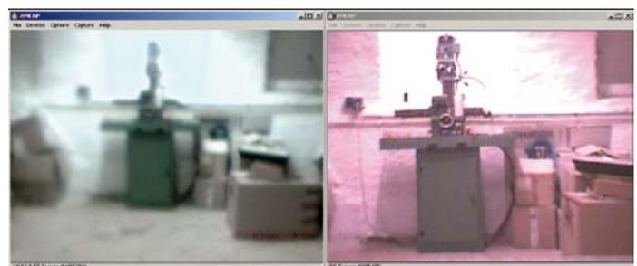
Bild 6. Die umgebaute Kamera sowohl in der Nacht als auch bei Tag zu verwenden ist keine gute Idee. Man müsste ansonsten bei jedem Wechsel von IR- und normalem Licht wieder manuell scharfstellen.
