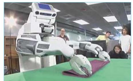
Objekten beizubringen. Der Aufwand für die Programmierung ist erheblich höher, als das beim Umgang des Roboters mit „festen“ Objekten der Fall ist. Zuerst musste ein neues Computerprogramm entwickelt werden, das die sich ändernden Sichtweisen des Roboters auf das Objekt berücksichtigt und daraus mathematische Algorithmen schafft. Beispielsweise muss der Roboter die Ecken des Handtuchs finden und wissen, wie er sie übereinander legen muss.
