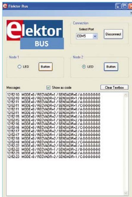
Bild 5. Screenshot der PC-Software. Unsere kleine Zentrale kann die LEDs der Knoten schalten und zeigt überdies alle Nachrichten an, die über den Bus laufen.
