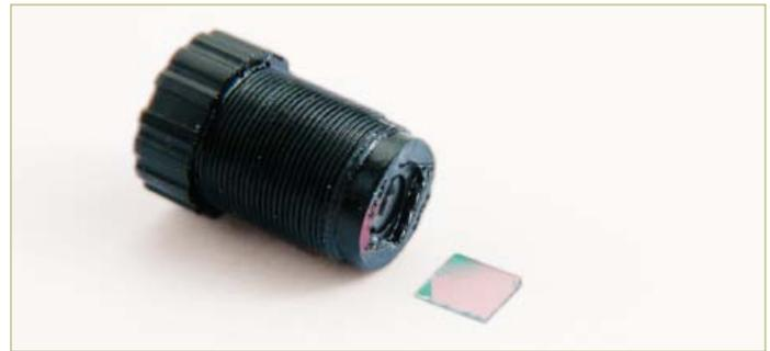
Bild 3. Bei der Webcam von König war die Entfernung des IR-Filters einfach.
