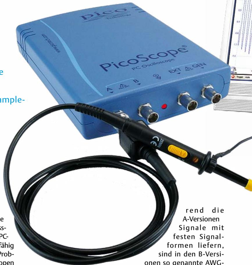
rend die A-Versionen Signale mit festen Signalformen liefern, sind in den B-Versionen so genannte AWG-Signalgeneratoren eingebaut (AWG=Arbitrary Waveform Generator). AWG-Signalgeneratoren können beliebige, vom Benutzer gestaltbare Signalformen erzeugen. Alle Modelle verfügen über interne Pufferspeicher, die Kapazitäten liegen modellabhängig zwischen 4 MSamples und 128 MSamples. Für unsere Begutachtung überließ uns Pico das Flaggschiff der PicoScope-Reihe 3000, das PicoScope 3206B.
