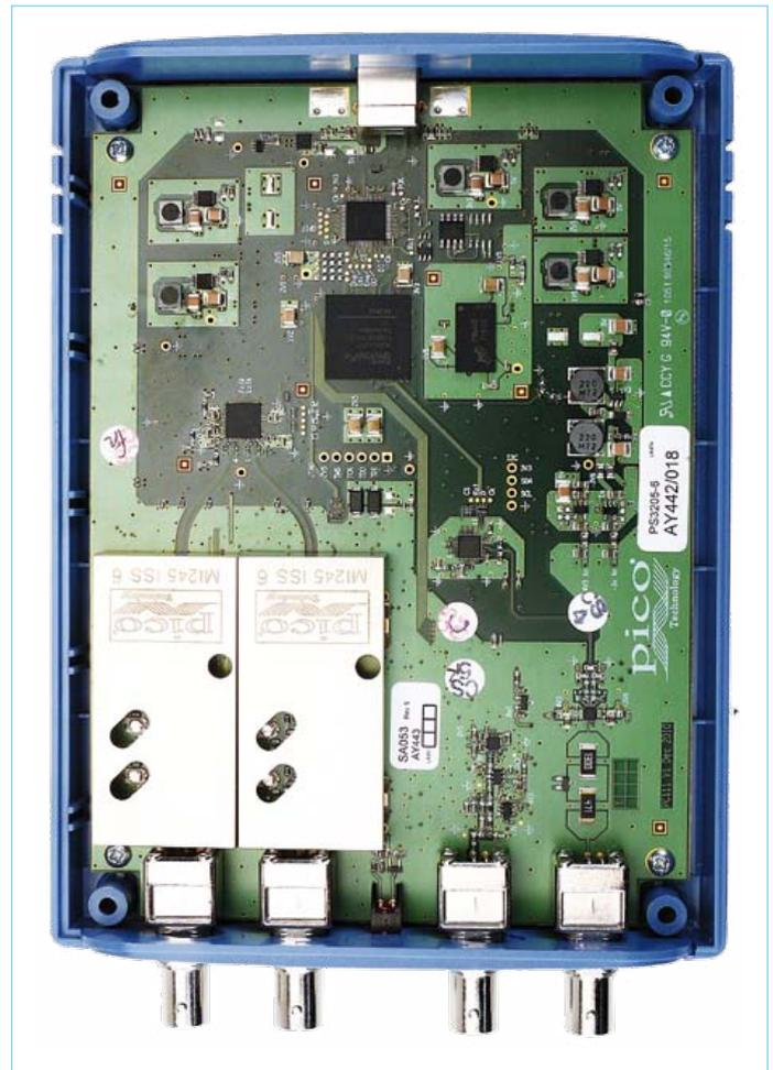
Bild 1. Blick in das PC-Oszilloskop 3206B von Pico. Auffällig sind die Abschirmungen der Eingangsstufen.
