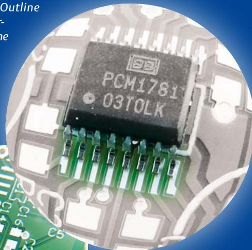
Der Pin-Abstand beträgt hier jedoch 0,635 mm, wobei die Differenz von 0,015 mm, das sind fünfzehn Tausendstel eines Millimeters, mit dem bloßen Auge nicht mehr wahrgenommen werden kann. Der minimale Unterschied macht sich
