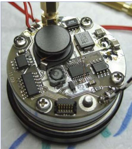
Bild 3. Die weitgehend SMD-bestückte kreisförmige Platine.
