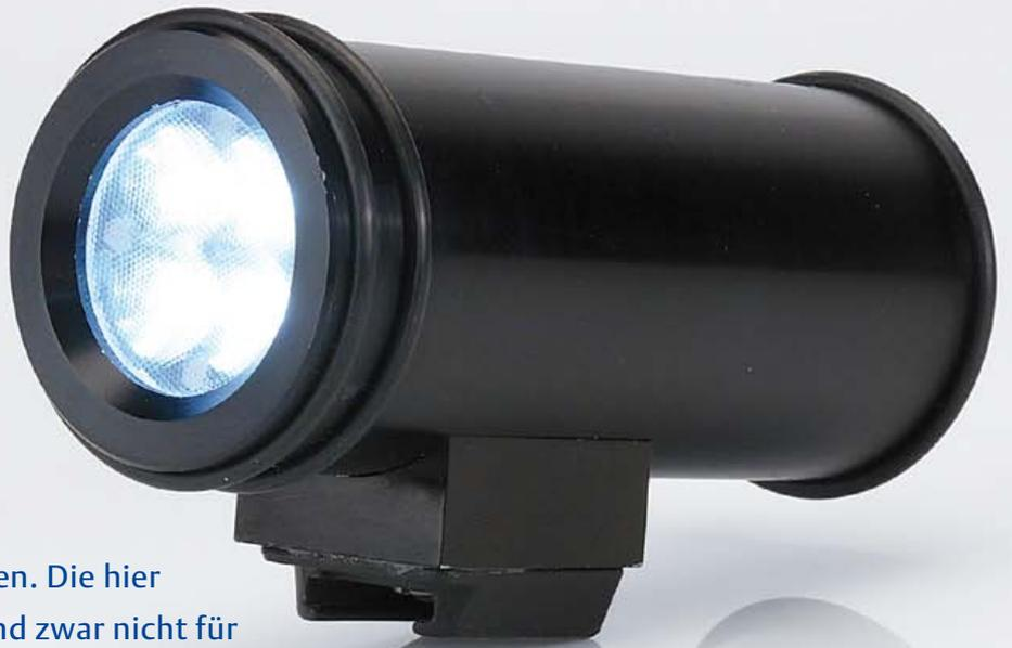
Die Akkukapazität von 2,2 Ah pro Zelle reicht bei voller Helligkeit im Gelände für etwa drei Stunden und im gedimmten Modus für ein Vielfaches davon. Der Mikrocontroller in der Schaltung übernimmt auch das Lademanagement, so dass zum Aufladen ein einfaches 5-V-Steckernetzteil oder ein Autoadapter ausreicht, der 5 V liefert.
