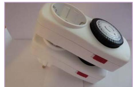
Schaltzeit der zweiten Schaltuhr kürzer als die Schaltzeit der ersten Schaltuhr sein. Mit einer dritten Schaltuhr lässt sich der 48-Tage-Zyklus noch weiter ausdehnen, er beträgt dann 2304 Tage, was ungefähr 6,5 Jahren entspricht.
