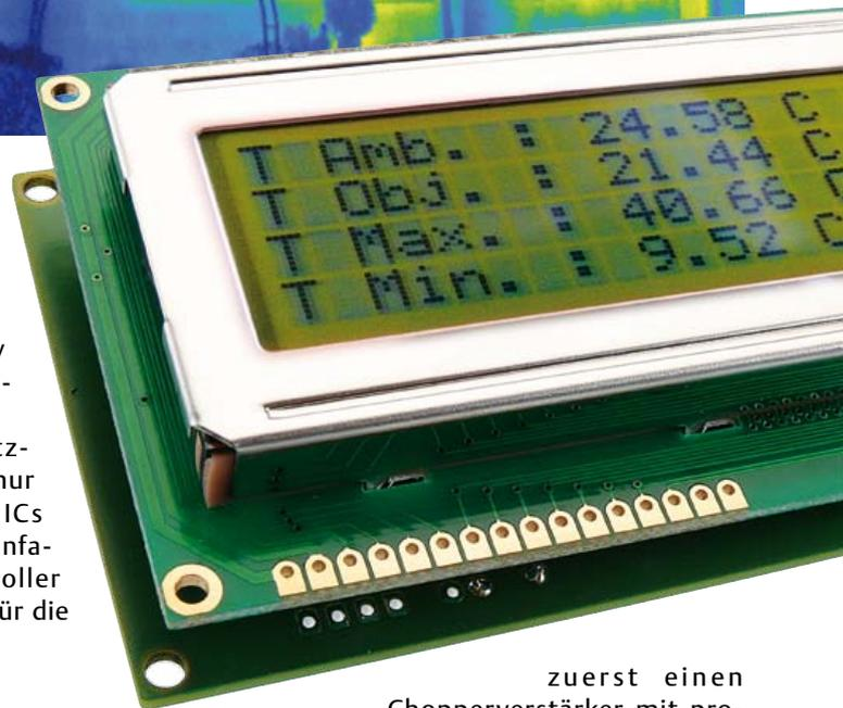
MLX90614, aber die Behandlung der PWM-Signale erfordert ein wenig mehr Finger-spitzengefühl als der SMBus. Außerdem beträgt die Auflösung nur 0,14 °C gegen-über 0,02 °C im SMBus-Modus. Den Baustein gibt es in einer 3-V- und in einer 5-V-Version, daher ist tunlichst auf die Verwendung der richtigen Version zu achten.
