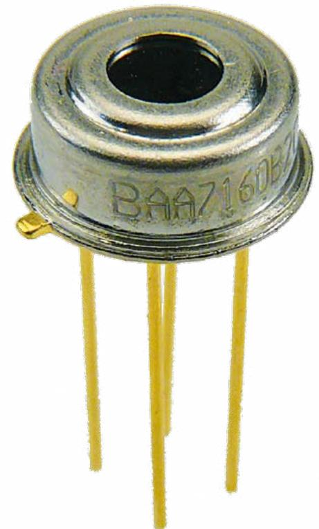
den. Die gängigste und preiswerteste Version ist der MLX90614ESF-BAA. Hier versteht „B“ auf eine Betriebsspannung von 3 V. Haben Sie einen MLX90614ESF-AAA erhalten, dann handelt es sich um eine 5-V-Version, die auch eingesetzt werden kann, wenn man D2, C4 und C7 nicht bestückt und R2 durch eine Drahtbrücke ersetzt.
