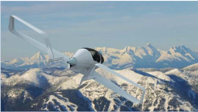
Bild 5. Die sechssitzige Synergy soll mit einem 142 kW (193 PS) starken Biodieselmotor am GFC teilnehmen.
