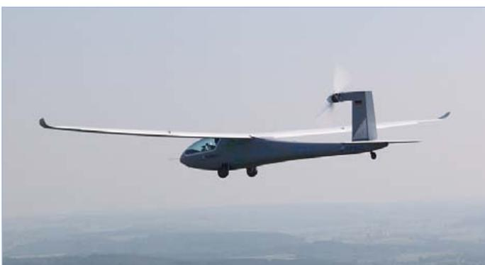
Bild 8. Der ursprünglich als „Hydrogenius“ mit Brennstoffzelle konzipierte e-Genius der Universität Stuttgart nimmt jetzt als sehr effizienter Elektroflieger am GFC teil. (Bild: e-Genius-Team, IFB Universität Stuttgart)
