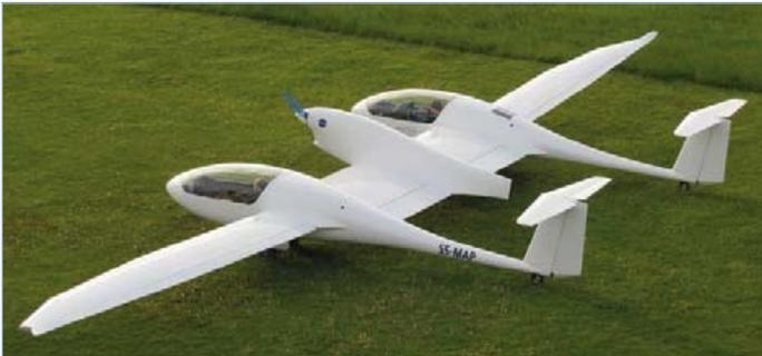
Bild 7. Pipistrel aus Slowenien hat für den GFC zwei Taurus-Motorsegler zu einem Doppelrumpf-Flugzeug mit 145-kW-Elektromotor kombiniert. Das gibt einen Sinn, weil der Wettbewerb den Verbrauch pro Sitzplatz wertet. (Bild: Pipistrel)
