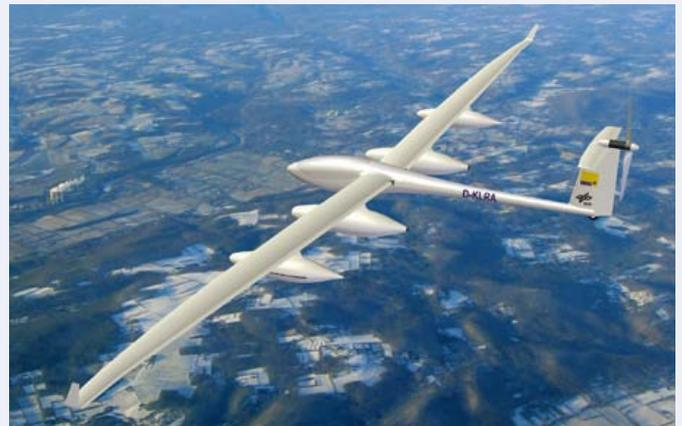
H3 [28] in Arbeit, der mit vier Außenlastbehältern, fest installiertem Heckpropeller und 23 m Spannweite schon ab 2012 gigantische Flugleistungen erreichen soll: 6000 km Reichweite und 50 Stunden Flugdauer mit 200 kg Nutzlast. (Bild: DLR)
