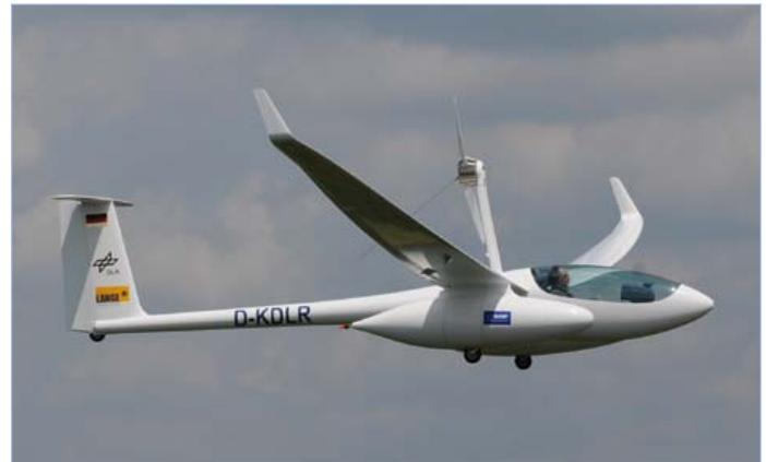
Bild 2. Der Antares 20E von Lange Aviation – hier in der DLR-Version mit Wasserstofftank und Brennstoffzelle in Flügelbehältern – ist das erste EASA-zugelassene Elektroflugzeug mit dem bisher einzigen als Flugtriebwerk zugelassenen Elektromotor. (Bild: DLR)
