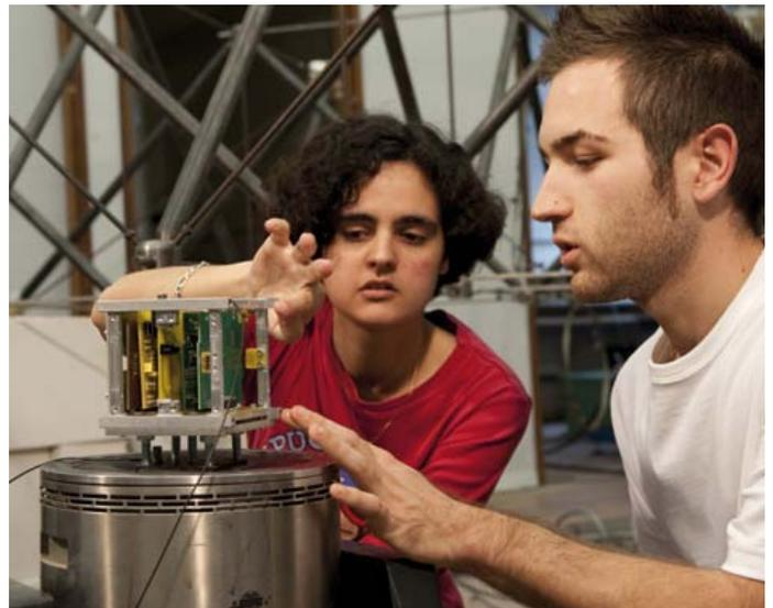
Vibrationstest des CubSats. (Quelle: CNES)
