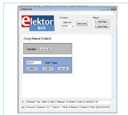
Bild 3. Anzeige der ADC- und Temperaturwerte im *ElektorBusBrowser*.
