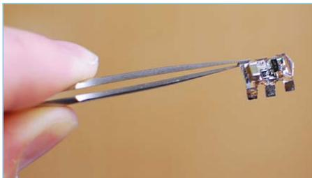
stem und diverse Lichtsensoren. Um solche Sprünge zu machen, greift der Roboter auf eine chemische Reaktion zurück, bei der ein Gas gebildet wird – eine Art kontrollierter Explosion. Den Sprung schafft er derzeit nur ein einziges Mal. Die weiteren Arbeiten zielen darauf ab, mehrere Sprünge auszuführen. In einer modifizierten Variante soll dann auch die Sprunghöhe ausgebaut werden. Ziel ist es, etwa 65 m zu erreichen – das 16.000-fache der Roboter-Länge!
