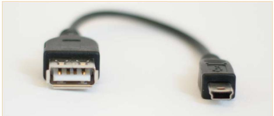
Bild 1. USB-Stecker für den Betrieb des Tablets im Master-Modus.
