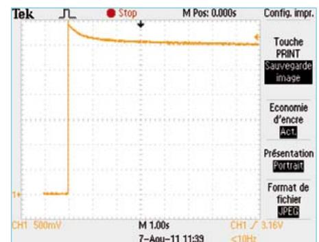
Bild 2. Die Temperatur des Ausblasdetektors stabilisiert sich innerhalb von wenigen Sekunden nach dem Einschalten.
