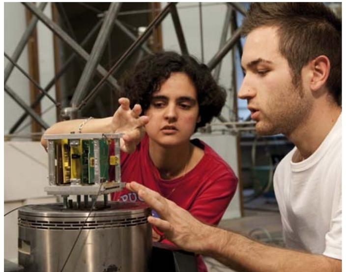
Vibrationstest des CubeSats. (Quelle: CNES)
