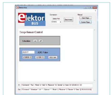
Bild 3. Anzeige der ADC- und Temperaturwerte im *ElektorBusBrowser*.
