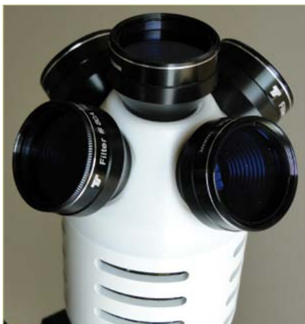
Bild 3. Konstruktion des Lichtmesskopfs mit den Blaufiltern.
