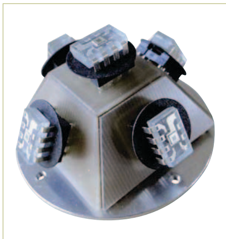
Bild 1. Die Lichtsensoren bilden zueinander feste Winkel.
