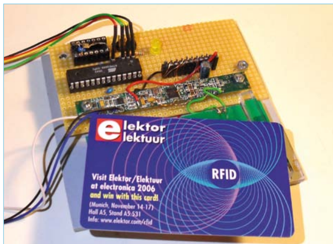
Bild 4. Musteraufbau mit ATmega88 und PN512-Readerplatine.
