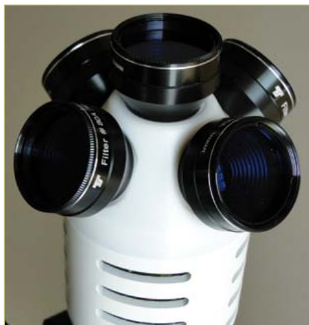
Bild 3. Konstruktion des Lichtmesskopfs mit den Blaufiltern.
