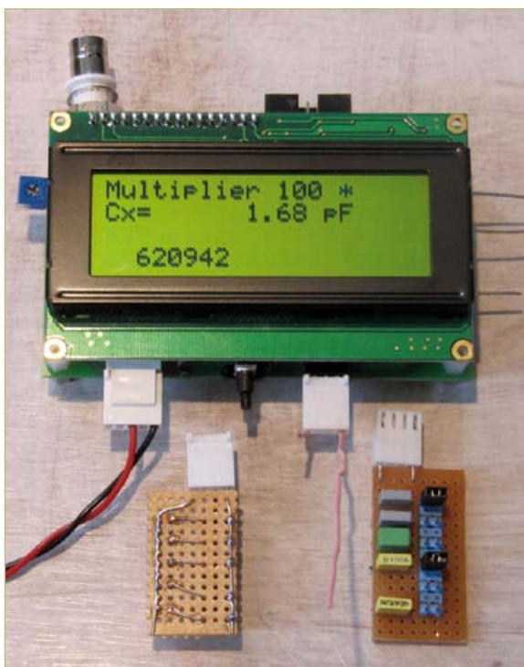
Bild 3. Mit diesem Zubehör untersuchte der Autor die Genauigkeit und die Linearität. Das vierzeilige Display zeigte beim Entwickeln zusätzliche Daten.
