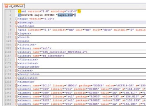
Bild 1. Die XML-Daten bestehen aus purem editierbarem Text.
