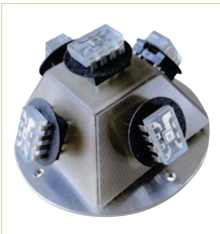
Bild 1. Die Lichtsensoren bilden zueinander feste Winkel.
