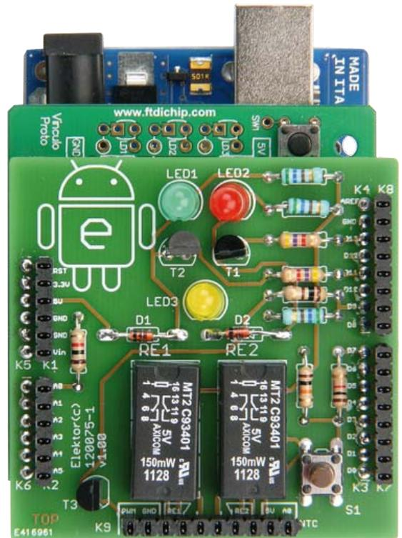
Hier zeigen wir, wie ein preisgünstiges Android-Smartphone als Benutzeroberfläche für ein Mikrocontroller-System eingesetzt werden kann. Zusammen mit einem Arduino-Board, ergänzt durch ein Bluetooth-Shield, realisieren wir drahtlose Mess- und Schaltfunktionen. Wir zeigen auch, wie die dazugehörige Android-App programmiert wird und welche kostenlose PC-Software für die Programmierung nötig ist.
