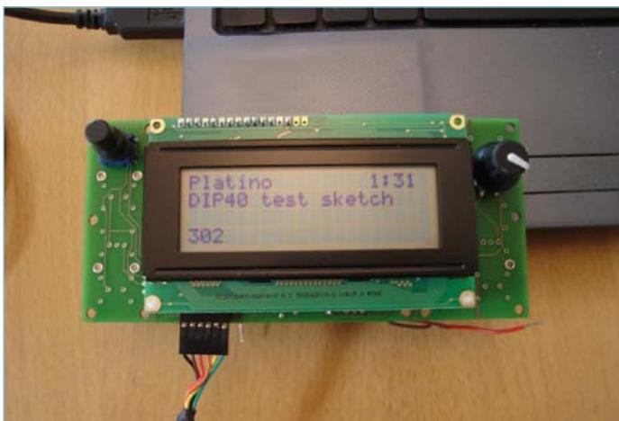
Bild 3. Test-Sketch von Bild 2, auf Platino laufend. Der Wert unten links (302) entspricht dem Status des Dreh-Encoders rechts. Der Timer-Wert oben rechts kann durch Betätigung des Tasters links zurückgesetzt werden.
