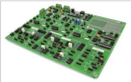
Wer anfängt sich ernsthaft mit Elektronik zu beschäftigen, kommt irgendwann mit den Grundbausteinen analoger Elektronik-Systeme in Berührung. Das Entwicklungsboard „Analog System Lab Kit PRO“ bietet die Möglichkeit, verschiedene Experimente aus der Welt der Analog-Elektronik selbst durchzuführen oder eigene analoge Systeme aufzubauen. Die von MikroElektronika für Texas Instruments produzierte Experimentierplatine dürfte damit auch für Studenten interessant sein.
