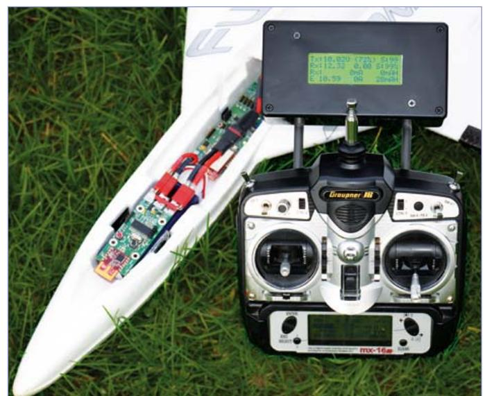
Bild 7. Dieses Flugmodell ist voll ausgestattet: Achtekanal-2,4-GHz-Empfänger und Fernmesssystem für die Akku-Parameter.
