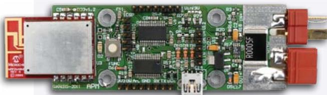
Der Transceiver-Typ MRF24J4MB hat eine Reichweite von ungefähr 1000 m im Freien. Auf dieser Platine wurde bereits ein Deans-Steckverbinder für den Akku montiert.
