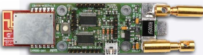
Diese Variante ist mit dem Transceiver MRF24J4MB bestückt. Der Akku wird an vergoldete 5,5-mm-PK-Steckverbinder angeschlossen, die Strömen bis 170 A gewachsen sind.
