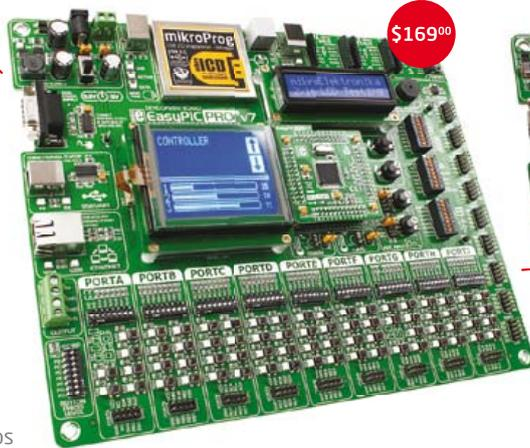
**EasyPIC™ v7** ist die siebte Generation unseres bekannten PIC-Entwicklungs-Boards. Seine duale Stromversorgung liefert 3,3 V sowie 5 V und unterstützt über 250 PIC-Mikrocontroller. Es enthält einen on-board-ICD, zwei mikroBUS™-Steckplätze sowie viele Module.
