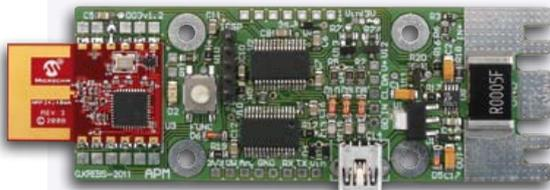
Ausgestattet mit dem 2,4-GHz-Transceiver MRF24J4MA von Microchip beträgt der Aktionsradius im Freien etwa 100 m. Der Akku-Anschluss ist hier noch nicht vorhanden.
