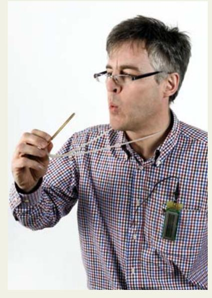
Pitotrohr so im Luftstrom positioniert, dass der Luftstrom die Messfühler und das Pitotrohr in gleichem Maß erfasst (siehe Bild 10). Potentiometer P1 (P5) wird so eingestellt, dass der angezeigte Wert mit der Anzeige des Pitotrohr-Systems übereinstimmt. Falls nötig muss die Verstärkung des DVM-Moduls korrigiert werden.
