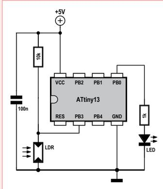
Mit einem Mikrocontroller lässt sich die Funktion eines Schmitt-Triggers ganz einfach realisieren. Man misst immer wieder die Eingangsspannung und vergleicht sie mit vorgegebenen Grenzwerten. In Abhängigkeit vom Ergebnis dieser Vergleiche wird dann ein Ausgang ein- oder ausgeschaltet. Die beiden Schaltschwellen werden unabhängig voneinander festgelegt. Damit hat man die
