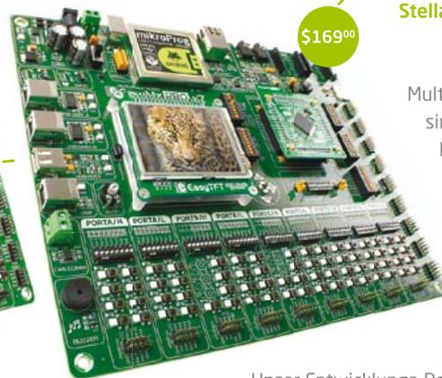
Unser Entwicklungs-Board **EasyMx PRO™ v7 für STM32®** unterstützt alle STM32™-Mikrocontroller. Neben dem mikroProg™-Hardware-Debugger enthält es schon on-board viele Module wie Multimedia, Ethernet, USB, CAN, zwei mikroBUS™-Sockel und vieles mehr.
