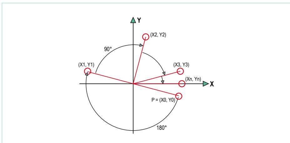
Bild 6. Funktionsweise der CORDIC-Rotation.
