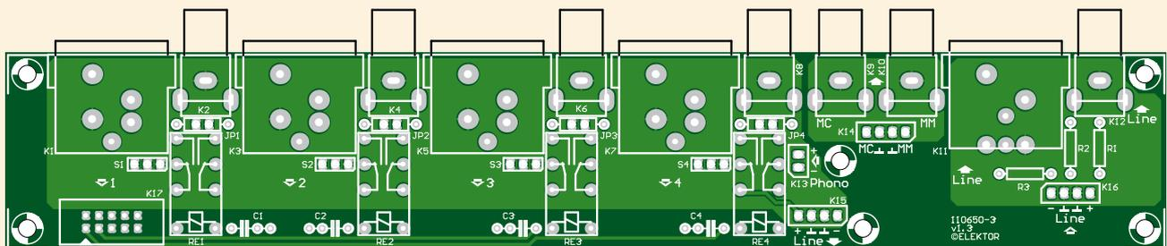
Bild 5. Die Eingangs-Platine (hier auf 75 % verkleinert). Für Stereo-Betrieb braucht man zwei davon. Die Platinen sind via [www.elektorpcbservice.de](http://www.elektorpcbservice.de) erhältlich.
