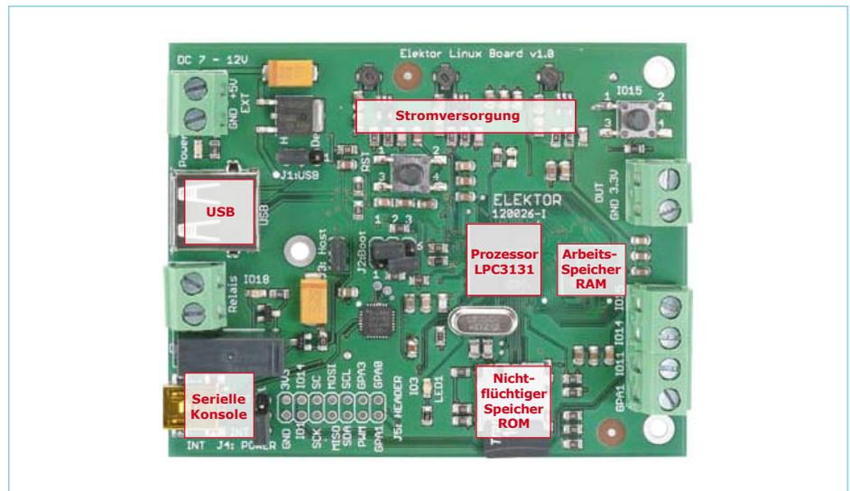
Bild 1. Die wichtigsten Komponenten des Elektor-Linux-Boards.
