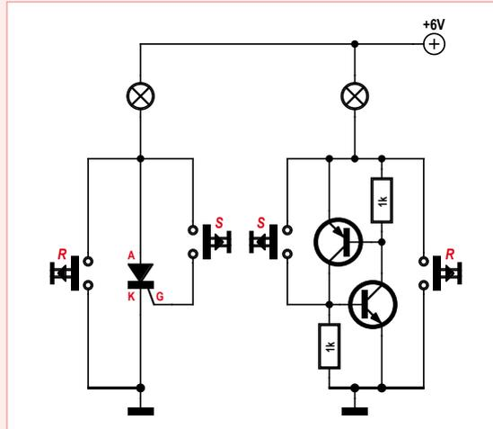
löschen muss er stromlos geschaltet werden: Man kann entweder die Betriebsspannung abschalten oder den Thyristor kurz überbrücken. Üblich ist auch ein Betrieb mit Wechselstrom, wobei die Nulldurchgänge jeweils den leitenden Zustand beenden.
