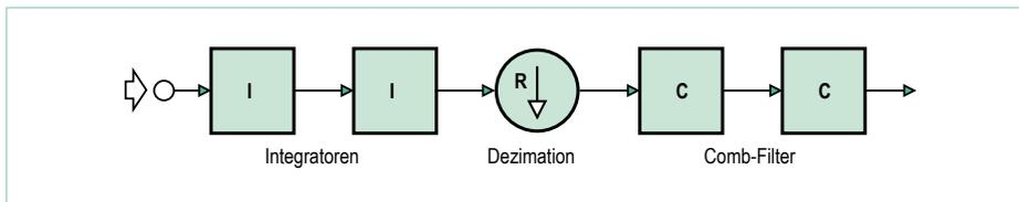
Bild 4. Die CIC-Struktur ist besonders effizient.
