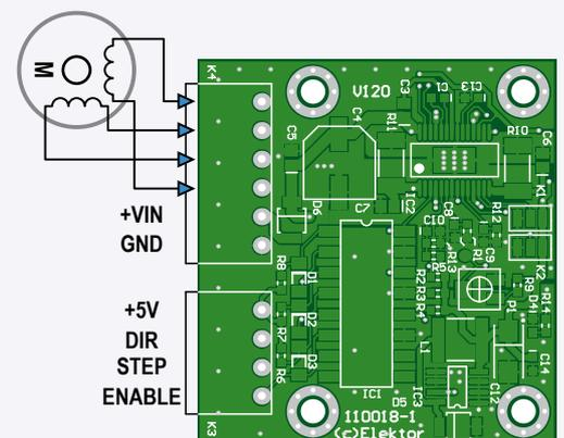
Bild 3. Die Platine ist mit SMDs bestückt, sie hat die kompakten Abmessungen 43 mm · 47 mm.
