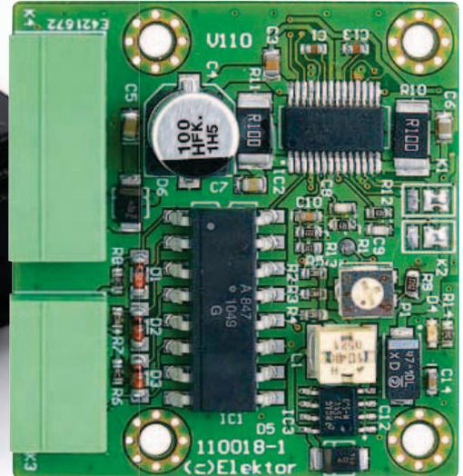
Ausgänge sind bis 2,5 A belastbar. Auf der Seite der Eingänge wird der Baustein durch Optokoppler galvanisch vom steuernden System getrennt. Das Anschließen an einen PC, beispielsweise an den Parallelport, ist problemlos möglich.
