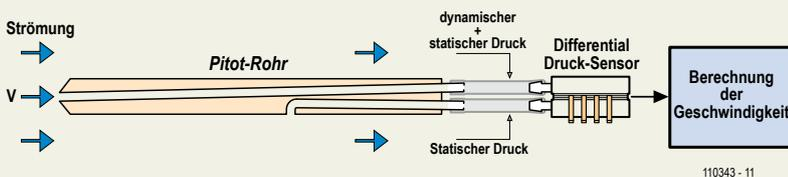
Messen von Strömungsgeschwindigkeiten mit Pitotrohr und Drucksensor.
