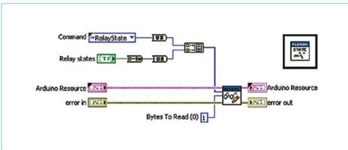
Bild 6. Das VI Relay State toggelt den Status der Relais. Der Status jedes Relais wird durch ein Bit im Datenbyte repräsentiert.
