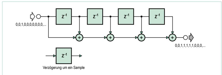
Bild 1. Filter mit gleitendem Mittelwert.
