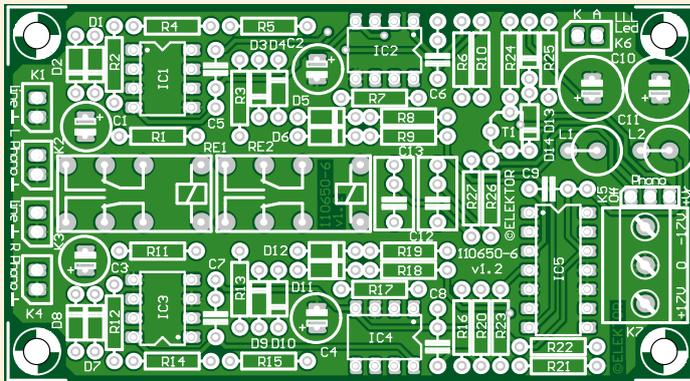
Bild 2. Die kombinierte Mess- und Treiberschaltung der LLLL-Anzeige kommt auf diese Platine, die via [www.elektorpcbservice.de](http://www.elektorpcbservice.de) erhältlich ist.
