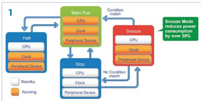
Nach jeder Datenoperation im Snooze-Mode wird eine „Match-Condition“ geprüft. Bei einem Match wird die CPU aufgeweckt und in den Run-Mode versetzt. Ohne Match folgt der Stop-Mode. Von daher wird die CPU nur dann aktiviert, wenn sie zur Bearbeitung empfangener oder erfasster Daten gebraucht wird. **Bild 2** illustriert den Snooze-Mode bei einem Timer-getriggerten ADC.
