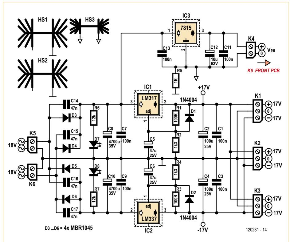
Bild 10. Die Netzteilschaltung kommt mit Wald- und Wiesen-Bauteilen aus und bietet wenig Überraschendes. Für die Relais ist ein eigener 15-V-Spannungsregler vorgesehen.
