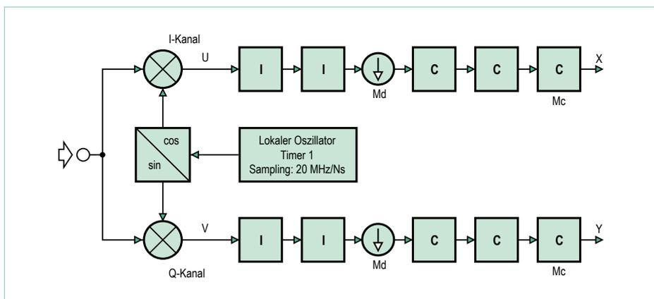
Bild 5. Blockschaltung der Kombination von Frontend mit Filtern.
