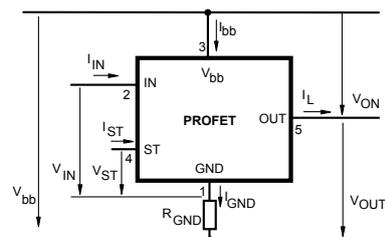
Bild 2. Ströme und Spannungen.
