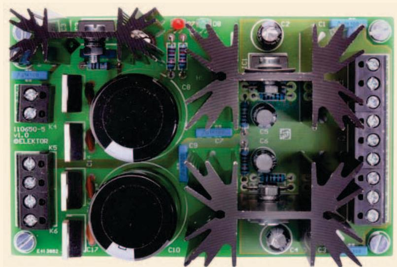
Bild 12. Die im Elektor-Labor bestückte Netzteil-Platine.
