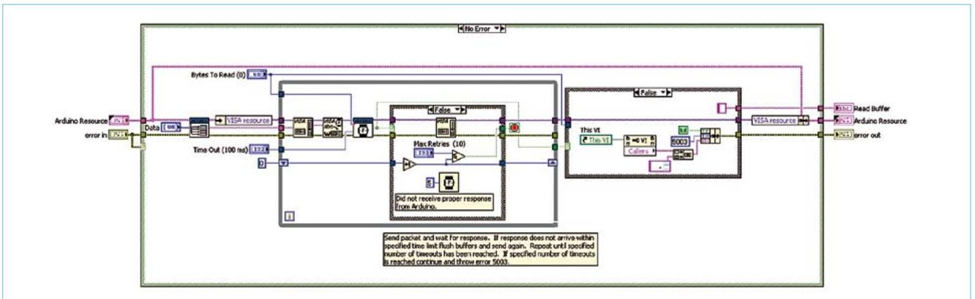
Bild 3. Im VI Send Receive sind die Pfade sichtbar, die bei einem Fehler durchlaufen werden. Im Normalbetrieb sind die schwarzen Case-Strukturen nahezu leer.
