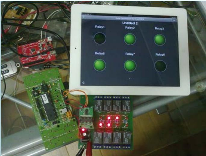
Bild 4. Das 8-Kanal-Relais-Board mit synchroner serieller Interface, das von LabVIEW gesteuert werden soll.
