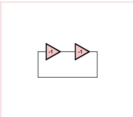
Bild 1. Prinzip des rückgekoppelten Verstärkers.
