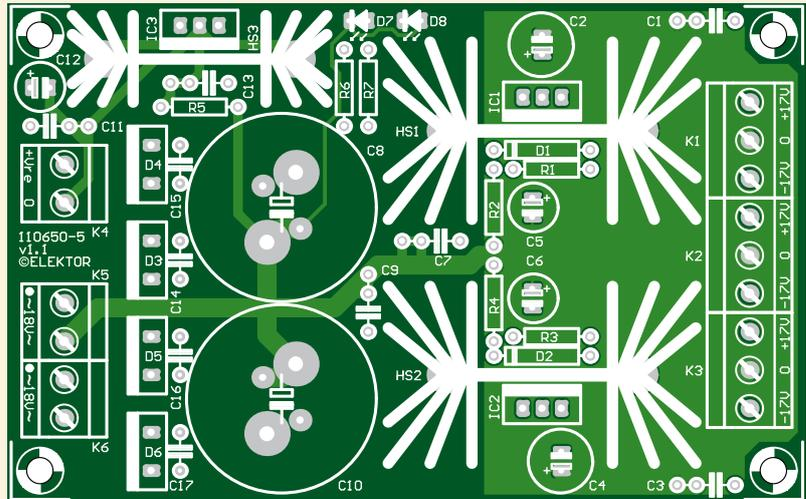
Bild 11. Die Platine des Netzteils ist via [www.elektorpcbservice.de](http://www.elektorpcbservice.de) erhältlich.
