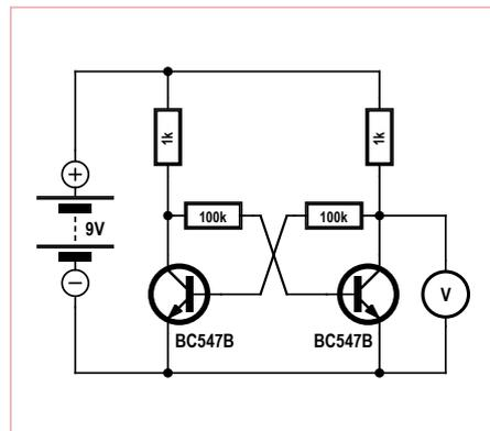
Bild 2. Bistabiles Flipflop mit zwei Transistoren.
