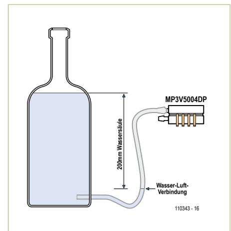
Bild 5. Mit dieser Hilfsanordnung kann der Drucksensor kalibriert werden.
