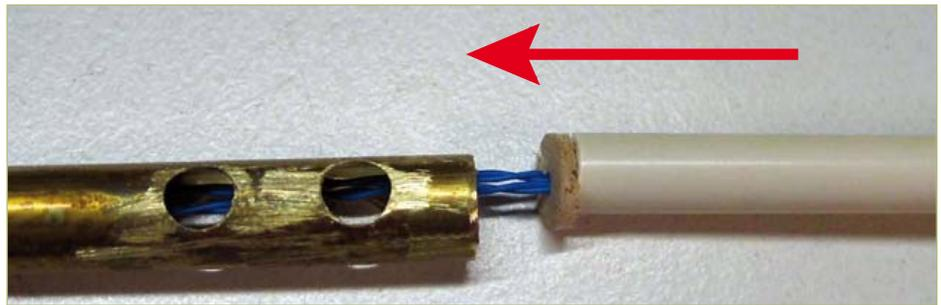
Bild 8. Ein Stück Kunststoffrohr und eine Holzscheibe halten den NTC-Sensor und das Anschlusskabel an ihrem Platz.
