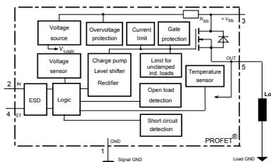
Bild 1. Funktionsschema und Anschlüsse.
