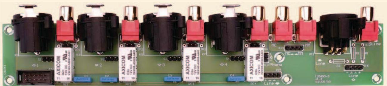
Bild 6. Fertig bestückte Eingangs-Platine.
