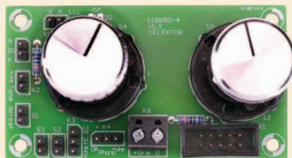
Bild 9. Die fertig bestückte Frontplatten-Platine.
