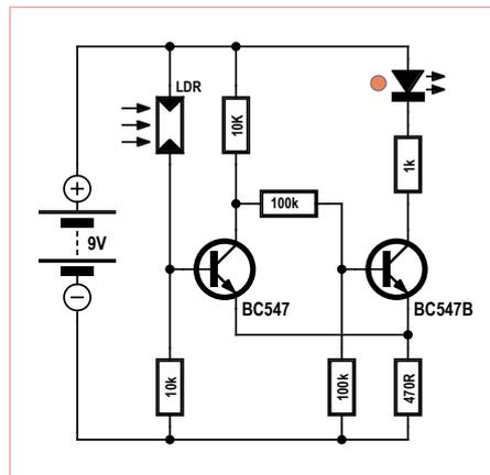
Bild 8. Ein Dämmerungsschalter.
