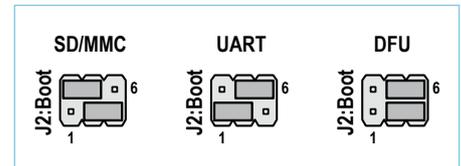
Bild 4. Bootloader-Jumper.
