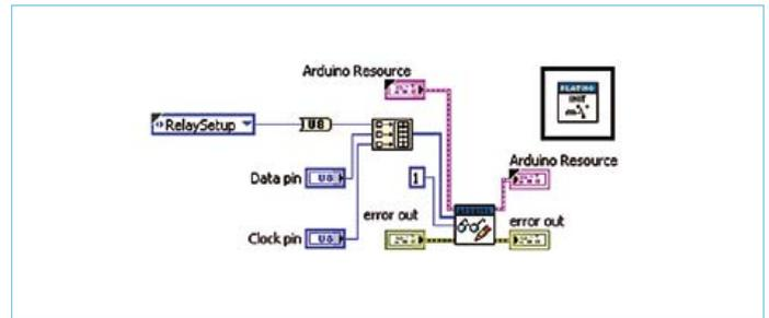
Bild 5. Das VI Relais Init wird zur Definition der Platino-Pins genutzt, die mit dem Relais-Board kommunizieren sollen.
