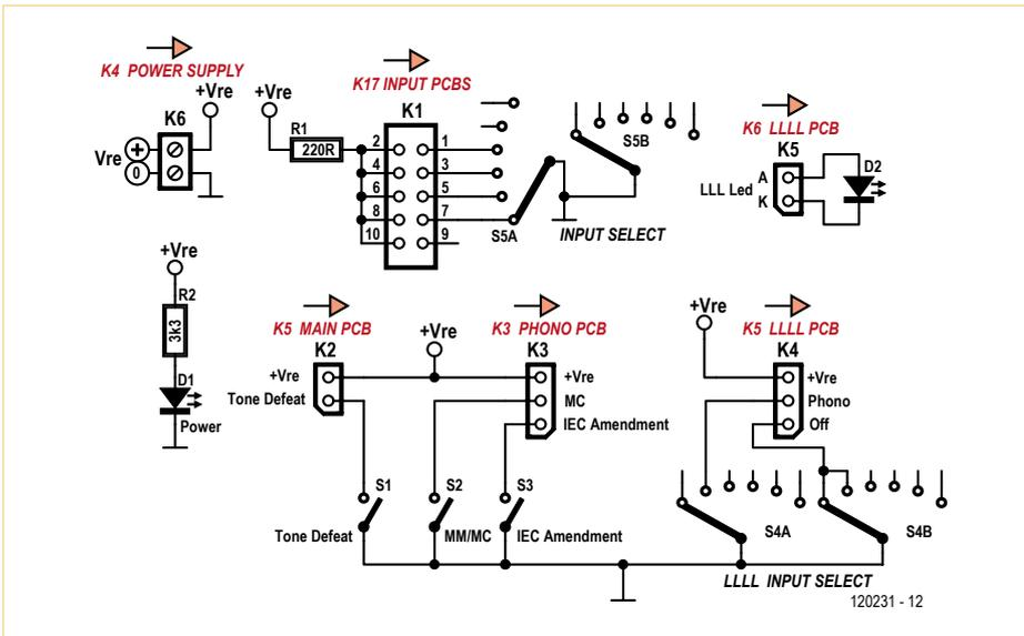
Bild 7. Schalter, LEDs, Widerstände und Steckverbinder erfordern eine eigene Platine, die mit der Frontplatte des Preamp verschraubt wird.
