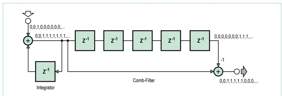
Bild 3. Umkehrung der Filterteile gegenüber Bild 2; aber gleiche Wirkung.
