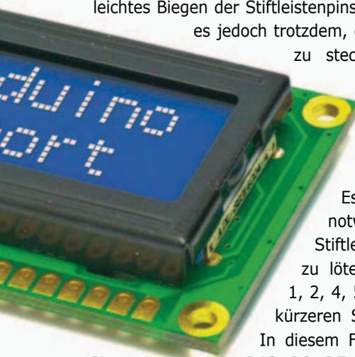
Leider weisen die beiden Buchsenleisten mit den Digitalpins auf den Arduino-Boards keinen Abstand von 2,54 mm zueinander auf (die Distanz ist etwas geringer). Durch leichtes Biegen der Stiftleistenpins des LCD-Moduls gelingt es jedoch trotzdem, die Stifte in die Buchsen zu stecken. Pin 8 des LCD-
