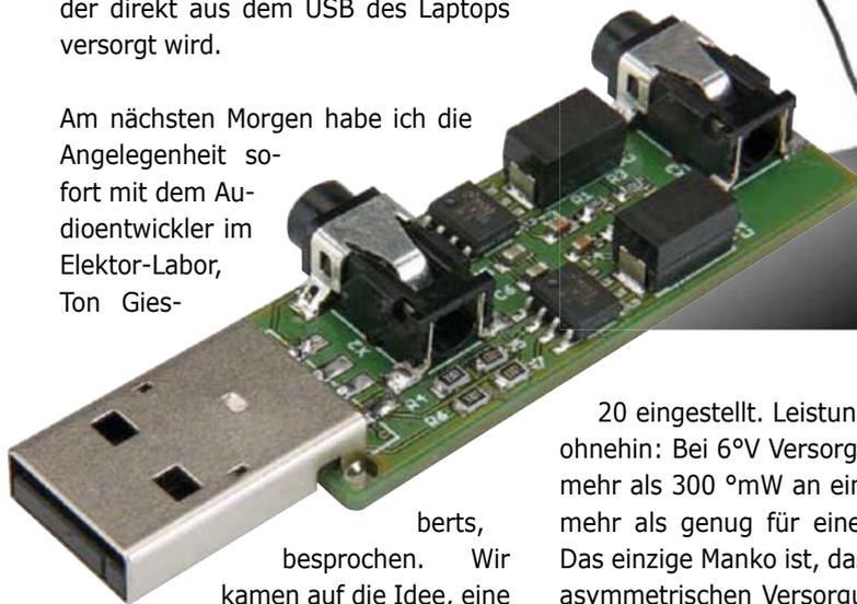
berts, besprochen. Wir kamen auf die Idee, eine kleine Platine zu entwerfen, auf der ein Paar LM386-Audioverstärker-ICs (Mono-Verstärker, für Stereo sind immer zwei Exemplare erforderlich) Platz findet. Die ICs arbeiten mit einer Versorgungsspannung von +5V, also genau das, was der USB-Port liefert. Der Hersteller Texas Instruments spricht nicht zu Unrecht von einem „Low Voltage Power Amplifier“. Der LM386 benötigt nur wenige externe Bauteile, die Verstärkung ist fest auf den Faktor
