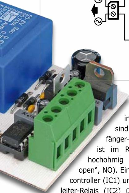
Sortimentern im Angebot sind. Der Empfänger-Ausgang ist im Ruhezustand hochohmig („normally open“, NO). Ein PIC-Mikrocontroller (IC1) und ein Halbleiter-Relais (IC2) übernehmen
