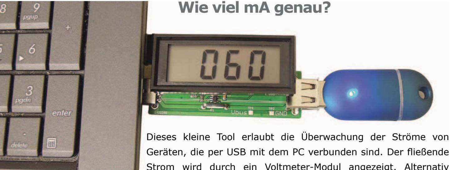
Dieses kleine Tool erlaubt die Überwachung der Ströme von Geräten, die per USB mit dem PC verbunden sind. Der fließende Strom wird durch ein Voltmeter-Modul angezeigt. Alternativ könnte man ihn aber auch per Oszilloskop erfassen.
