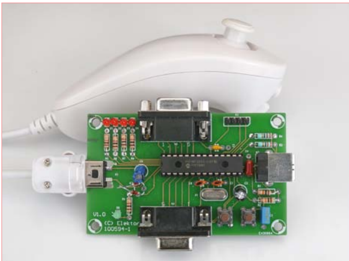
Bild 6. Für den Nunchuk-Stecker müssen in die Platine zwei Nuten gefräst oder gesägt werden.
