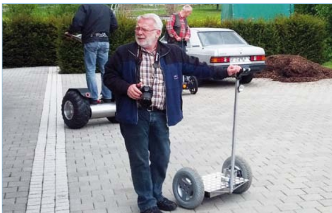
Hier steht Wolfgang (Mitte) neben seinem Eigenbau auf der Basis von Rollstuhlmotoren. Sein selbstbalancierendes Zweirad fährt zwar nicht so schnell, aber gut.
