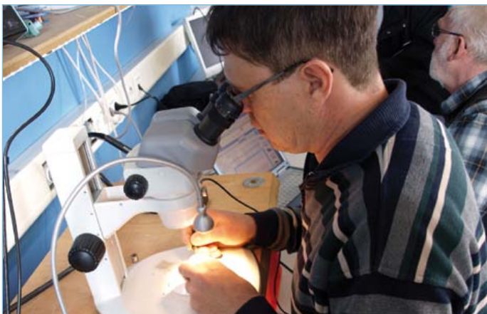
Selbstverständlich wurde auch gebastelt und getüftelt. Hier lötet Günter ein paar SMDs unterm Stereo-Mikroskop.
