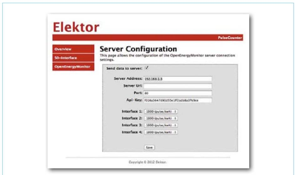
Bild 4. Konfiguration des OpenEnergyMonitor-Servers.
