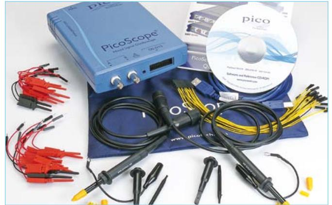
Ein so genanntes MSO (Mixed Signal Oscilloscope) kombiniert ein Oszilloskop mit einem Logic-Analyser, deren Anzeigen bei Bedarf auf einem Bildschirm erscheinen. Als das Einsteiger-MSO 2205 von Pico Technology [1] auf unter 400 € fiel, beschlossen wir, ein Muster zu besorgen und es im Elektor-Labor zu testen.
