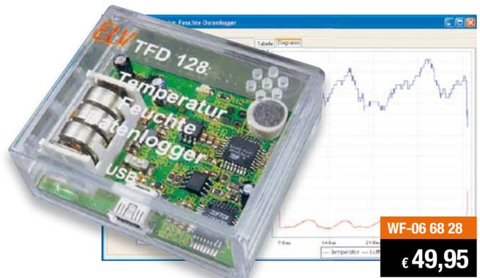
Der batteriebetriebene Datenlogger sammelt an seinem Einsatzort über einen integrierten Sensor automatisch Temperatur-/Luftfeuchtedaten für bis zu 151 Tage (nur Temperatur: bis 227 Tage) und stellt diese über eine USB-Schnittstelle einem PC zur Auswertung zur Verfügung. Damit sind Klimadaten auch an weit abgelegenen Orten über lange Zeiträume erfassbar. Über ein Auswerteprogramm sind die Da-
