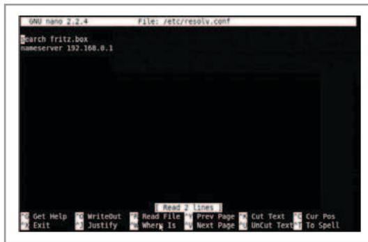
Bild 4. Konfiguration des DNS-Servers.
