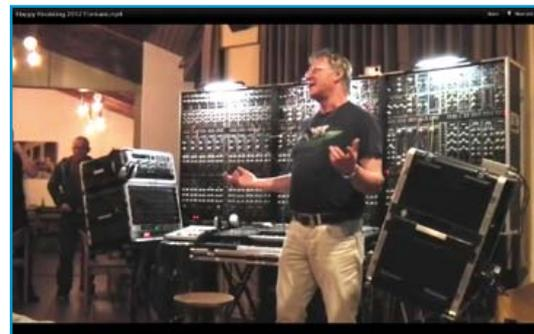
Siegfried schrieb uns: „In Phase 3 bestand das Projekt aus über 160 Modulen der Elektor-Formant-Bücher 1 & 2 sowie einigen Spezialitäten und diskreten Schaltungen. Alles ist über eine Modul-Wand verbunden. Über ein Achtwege-MIDI-Interface kann der Formant über MIDI und CV/Gate gesteuert werden.
