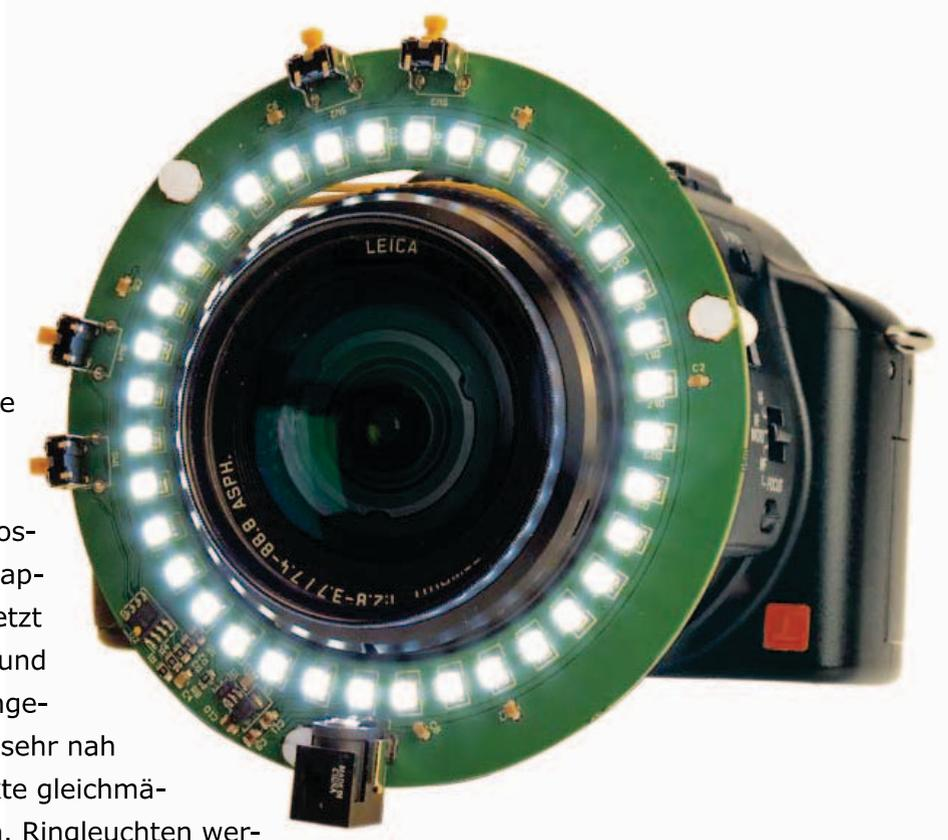
Traditionelle Ringleuchten verwenden ringförmige Fluoreszenzröhren, deren Helligkeit man nur mit einem aufwändigen und teuren Fluoreszenz-Dimmer einstellen kann. Dieser Nachteil lässt sich durch den Einsatz weißer Hochleistungs-LEDs umgehen. Die hier gezeigte Schaltung besteht aus einem Array von 36 LEDs, die von einem programmierbaren und speziell zur Ansteuerung von LEDs geeigneten Konstantstrom-Aufwärtswandler gesteuert werden.
