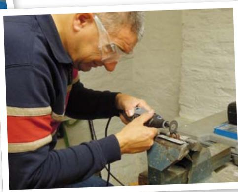
Mit einer Dremel oder einem ähnlichen Werkzeug, in das sich eine Trennscheibe für Metall einspannen lässt, beginnt man nun im rechten Winkel in Bezug auf den Ring zu schneiden. Tragen Sie einen Augenschutz!
