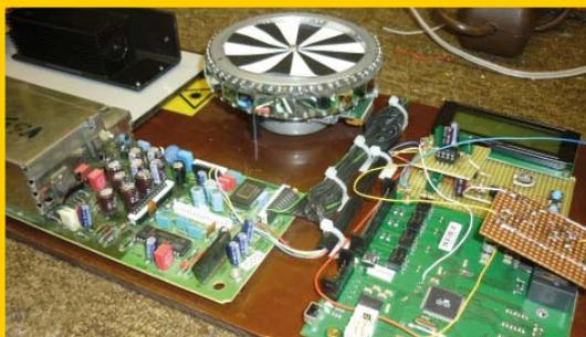
Das Projekt Laser-TV von OP hpt möchte ein Videobild mit Hilfe von 30 rotierenden Spiegeln auf einem VHS-Kopfmotor an die Wand werfen. Anfängliche Versuche waren vielversprechend, die größte Herausforderung ist die Phasensynchronisation der Kopfplatte. Der OP sucht interessierte BASCOM-Programmierer, die eine Motor-PLL (oder eine ähnliche Softwarelösung) entwickeln.
