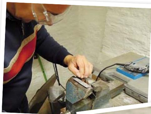
Spannen Sie den Ringkern nun erneut so ein, dass Sie bequem einen zweiten rechtwinkligen Schnitt durchführen können. Vorsicht: Der Ringkern verliert durch den Schnitt seine Festigkeit und das Material ist ziemlich spröde.
