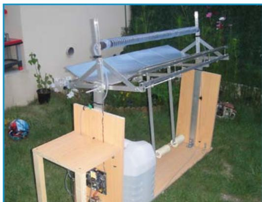
Diese Warmwasseranlage basiert auf dem RL78-Evaluations-Board und wurde dazu entwickelt, das Maximum des verfügbaren Sonnenlichts auf ein Wasserrohr zu bündeln, um dieses kontinuierlich zu erhitzen. Der Reflektor ist mit einem Gegengewicht für einfaches Kippen versehen und wird automatisch so verstellt, dass ein Maximum des Sonnenlichts mit dem geringsten Strombedarf reflektiert wird.
