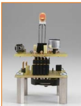
Um eine komfortable LED-Kerze aufzubauen, werden hier ein Tiny-Controller und eine Duo-LED eingesetzt.
