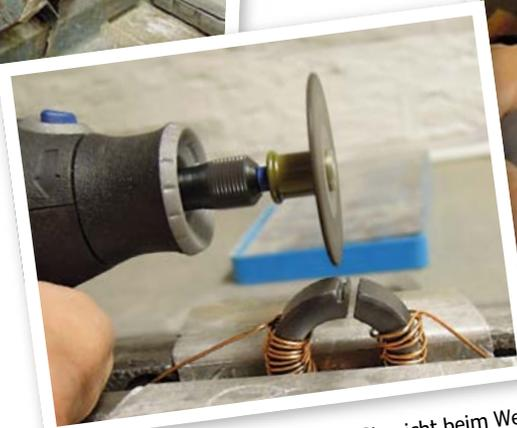
Nehmen Sie sich Zeit und drücken Sie nicht beim Weg durch den Kern. Die Trennscheibe ist zum Trennen und nicht zum Schleifen geeignet und bricht leicht, wenn sie rechtwinklig zum Radius belastet wird.
