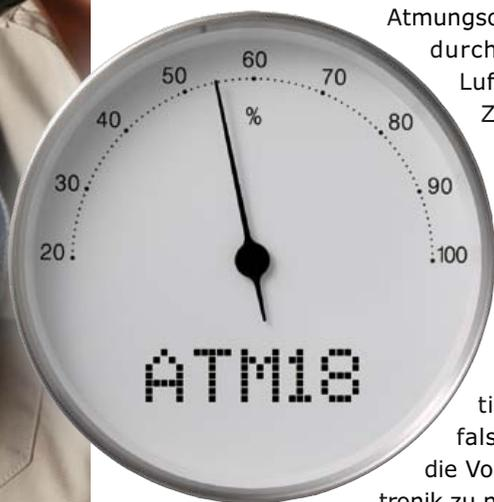
Für diese Anwendung habe ich den digitalen Sensor *DigiPicco* [1] ausgewählt, dessen Daten in Tabelle 1 angegeben werden. Er ist ab Werk kalibriert, was die Inbetriebnahme erleichtert. Die Nutzsignale können an größeren Kupferflächen abgenommen werden.
