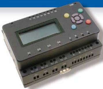
Ein MIAC (**Matrix Industrial Automotive Controller**) ist eine Steuerungseinheit für den industriellen Bereich, der die Steuerung einer breiten Palette von elektronischen Systemen im Bereich Sensorik, Überwachung und Automotive erlaubt. Intern arbeitet ein MIAC mit leistungsfähigen Mikrocontrollern der PIC18-Serie und verfügt über USB. Das Modul kann mit Flowcode, C oder Assembler programmiert werden.
