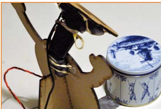
Bild 4. Von hinten sieht man die Halskonstruktion des Kekswächters.
