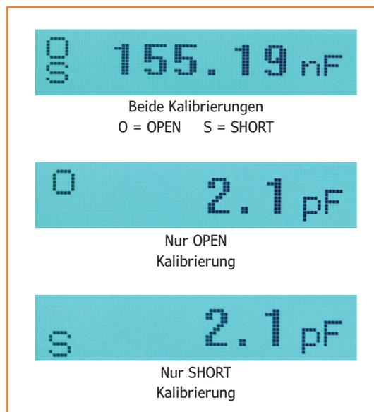
Bild 8. Warnung wegen einer fehlerhaften Eichung.
