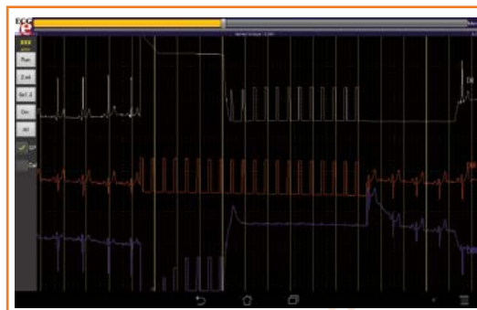
Bild 27. Ist die Checkbox „Cal“ aktiviert, wird im 10-Sekunden-Abstand das Kalibriersignal (2 Hz, 1 mV) eingeblendet.
