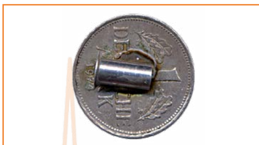
Bild 30. Die gute alte D-Mark und auch ein Franc sind noch nicht wertlos. Mit aufgelöteter Bananenstecker-Buchse wird die Münze zur Elektrode für das Elektor-Kardioskop.
