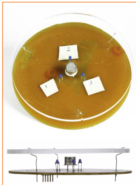
Bild 5. Über der Platine des Windrichtungssensors wird in ungefähr 2 cm Abstand eine gleich große, runde Scheibe montiert, die mit Alufolie kaschiert ist. Hier besteht die Scheibe zur Anschauung aus Acrylglas.
