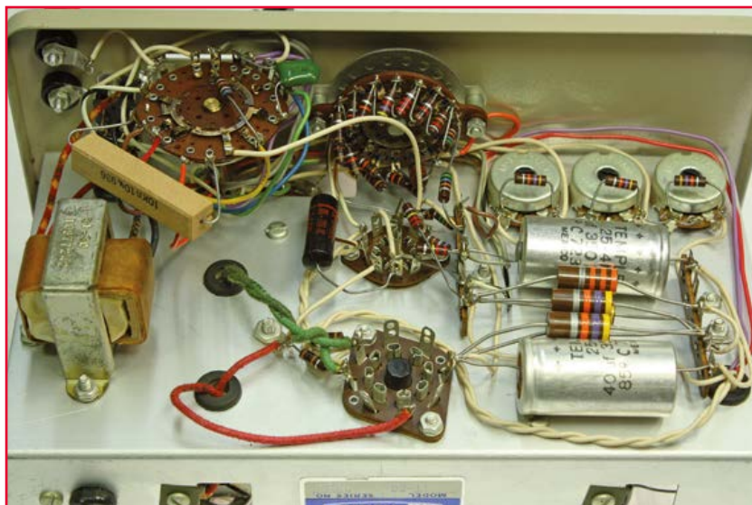
Bild 6. Die Innenansicht der rechten Seite des IT-28. Links im Bild sieht man den Bridge/Discharge/Leakage-Schalter. Am Schalter in der Mitte fällt die Widerstandskette auf, mit der man die gewünschte Arbeitsspannung wählt. Mit den drei Pots rechts stellt man die Schwellen der Leckströme für die drei Kondensator-Typen ein.
