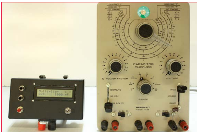
Bild 1. Das IT-28 kommt auf ordentliche 2,2 kg und benötigt das Stromnetz. Das batteriebetriebene Pico C-Super ist dagegen ein Leichtgewicht - nicht aber bezüglich seiner Fähigkeiten. Das magische Auge ist bei abgestimmter Brücke offen.
