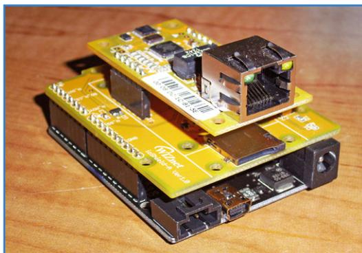
Bild 8. Wenn Sie einen ausgefallenen Server mit vielen Eye-Catchern mögen, ist eine MicroSD-Karte der richtige Weg. Die WIZnet-ioShields verfügen über die Kartenaufnahme und sind für verschiedene Plattformen verfügbar. Hier ist die Arduino-Version zu sehen.
