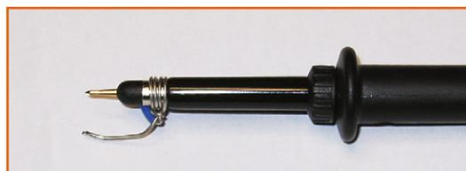
Bild 4. Tastkopf der Firma Hameg mit selbstgebauter „Massefeder“. Auch hier wurde das Massekabel entfernt.
