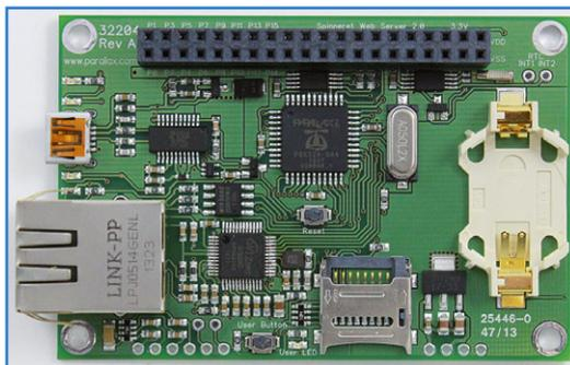
Bild 12. Der Spinneret-Web-Server 2.0 von Parallax ist eine der ersten Plattformen mit dem W55
