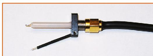
Bild 6. Älterer niederohmiger Tastkopf von HP.
