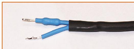
Bild 5. Selbstgebauter niederohmiger Tastkopf.
