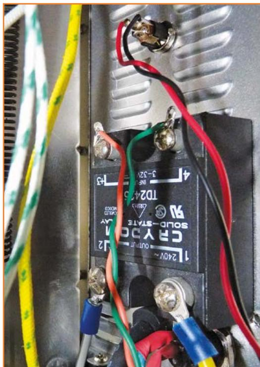
Bild 8c. Nahansicht des Solid-State-Relais und des 5-V-Anschlusses.
