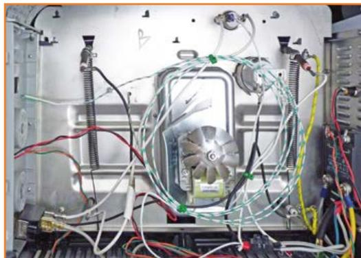
Bild 8b. Der Sicherheitsthermostat, Typ Klixon, ist eingebaut.
