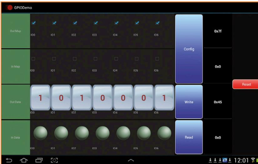
Bild 2. FTDI liefert acht Demo-Android-Apps mit, hier diejenige zum Setzen der digitalen Ein- und Ausgänge.
