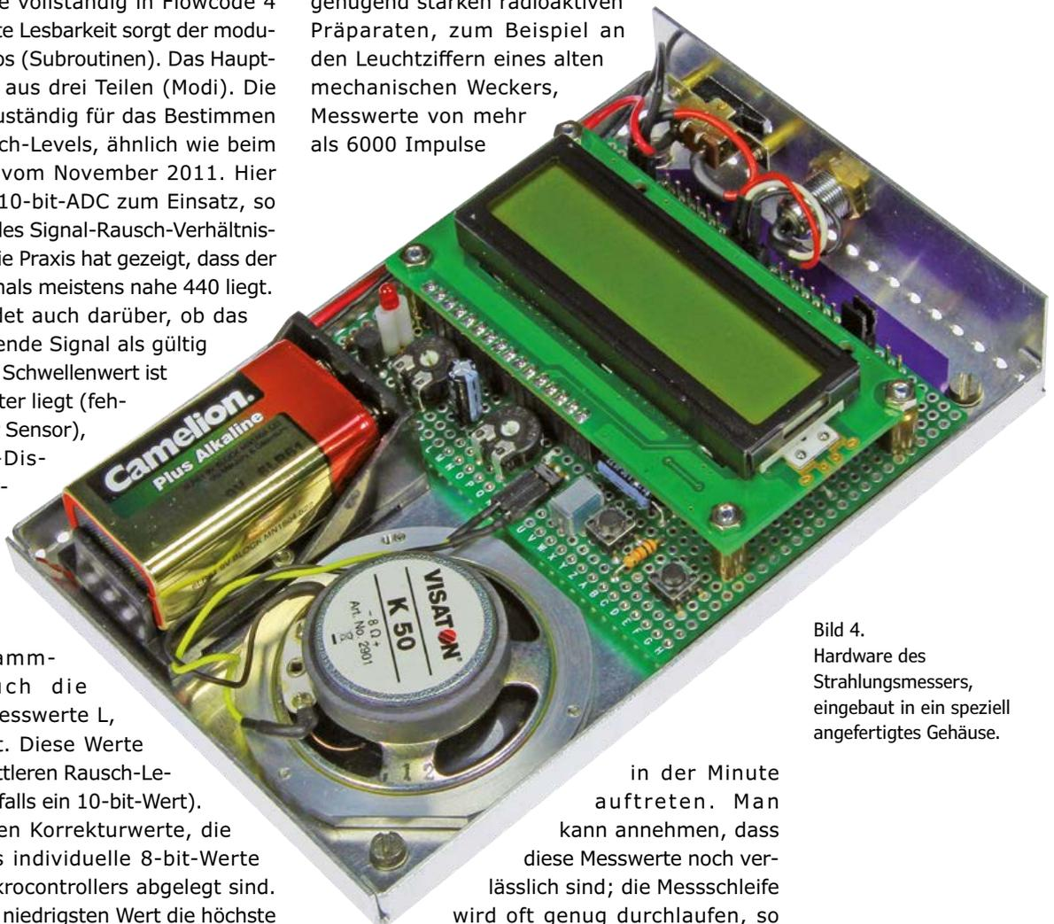
Bild 4. Hardware des Strahlungsmessers, eingebaut in ein speziell angefertigtes Gehäuse.
