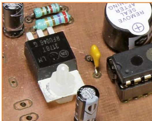
Bild 6. Auf der Bestückungsseite muss zwischen Spannungsregler und Kupferfläche ein Zwischenraum eingehalten werden.
