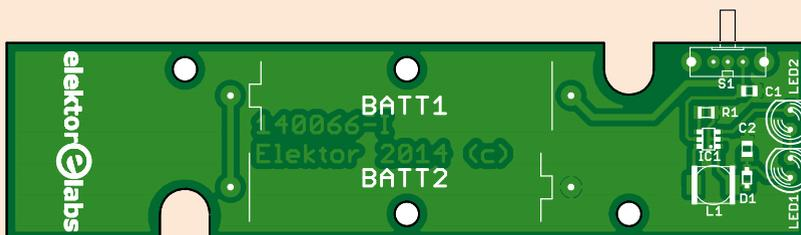
Bild 2. Der Bestückungsplan der vom Elektor-Labor entwickelten Platine.
