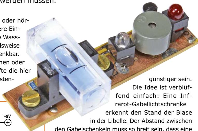
günstiger sein. Die Idee ist verblüffend einfach: Eine Infrarot-Gabellichtschranke erkennt den Stand der Blase in der Libelle. Der Abstand zwischen den Gabelschenkeln muss so breit sein, dass eine Libelle mit den Abmessungen 30 x 10 x 10 mm dazwischen passt. Der Fototransistor der Lichtschranke lässt die LED1 aufleuchten, gleichzeitig steuert er über T1 den akustischen Signalgeber BZ1.
