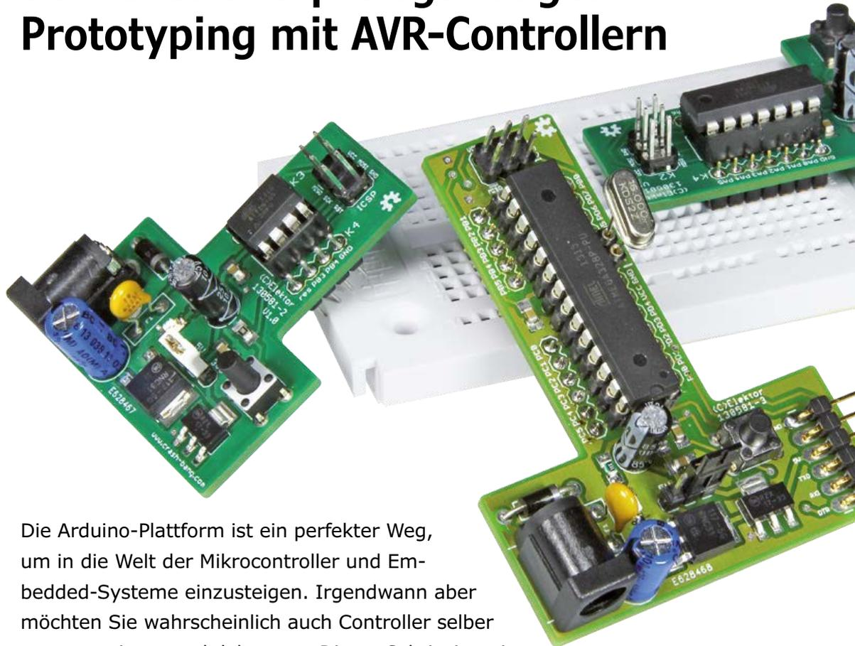
Die Arduino-Plattform ist ein perfekter Weg, um in die Welt der Mikrocontroller und Embedded-Systeme einzusteigen. Irgendwann aber möchten Sie wahrscheinlich auch Controller selber programmieren und debuggen. Dieser Schritt ist mit den T-Boards leicht gemacht.
