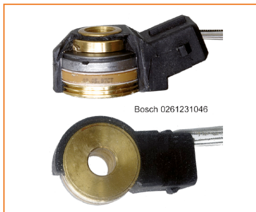
Bild 1. In diesem Klopfsensor befindet sich eine Scheibe aus piezo-elektrischem Material, eingebettet zwischen metallischen Scheiben.
