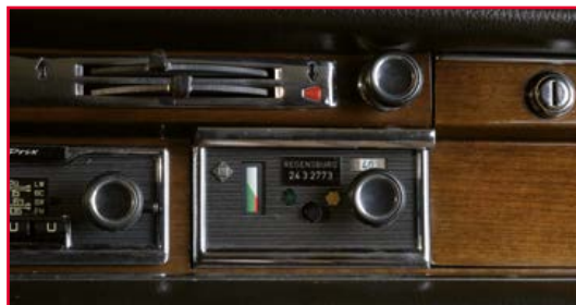
Bild 9. Spezialversion des Steuergeräts für das Armaturenbrett eines Mercedes W108/W109. Abbildung mit freundlicher Genehmigung von oeb1.de.
