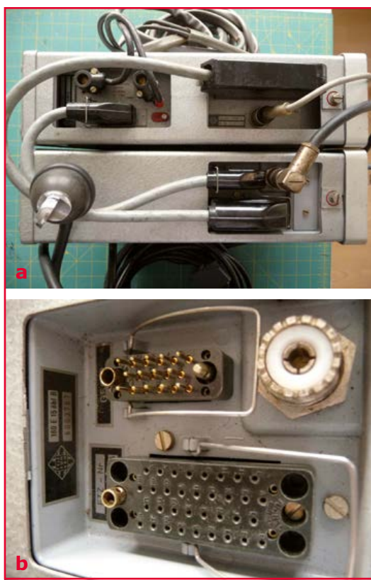
Bild 3. (3a) Kabel zwischen dem Modul S/E 169E15 öbL B und der Stromversorgung. (3b) Seitenansicht: Steckverbinder des Telekommunikationsmoduls.
