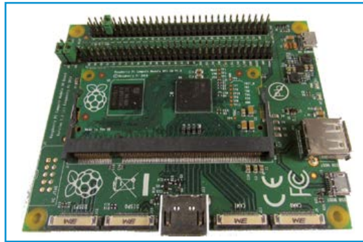
Bild 2. Eine solche Menge an I/O-, Versorgungs- und Steuerleitungen an 200 mikroskopisch kleinen Leiterbahnkontakten eines SO-DIMMs verlangen nach einem geeigneten „Motherboard“. Hier ist das CM in ein CM IO-Board gesteckt und stellt eine Art Super-RPi dar.
