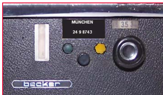
Bild 8. Das Steuergerät AT400 des Herstellers „Becker“ für den formschönen Einbau ins Armaturenbrett. Abbildung mit freundlicher Genehmigung von oebf.de.
