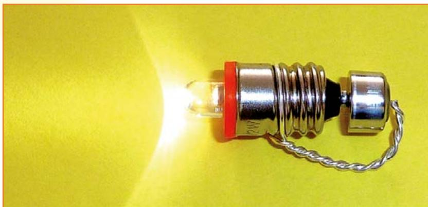
**Bild 1.** Step-up-Konverter samt LED, integriert in das E-10-Schraubgehäuse eines Glühlämpchens. Dahinter ist eine kleine Knopfzelle vom Typ AG5 (1,5 V mit 60 mAh) zu sehen, die für über eine Stunde Dauerlicht sorgt.
