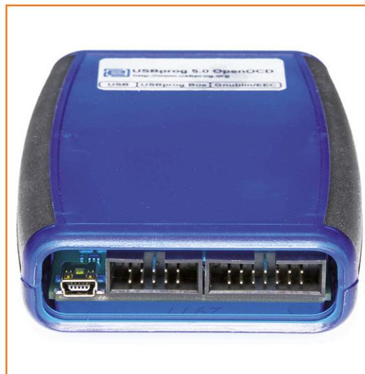
**Bild 2.** Anschlüsse des USBprog 5.0. Rechts erkennt man den 14-poligen GnuBlin/EEC-Steckverbinder; nach einem Firmware-Update werden sich später auch einmal die GnuBlin-Erweiterungsboards ansteuern lassen.
