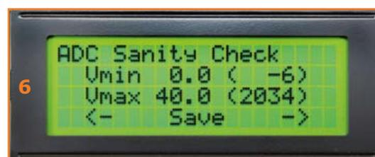
Bild 1...6. Auf dem LC-Display erscheinen diese Seiten: 1 = Startseite, 2 = Hauptseite, 3 = Setup, 4 = Kalibrierung 1, 5 = Kalibrierung 2, 6 = Status.
