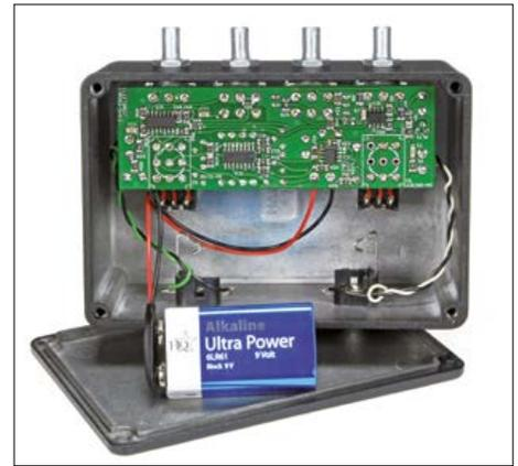
Bild 4. So werden die Platine, die Schalter und die Batterie in einem stabilen Metallgehäuse untergebracht.
