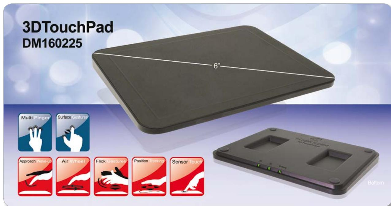
Microchip präsentiert mit dem 3DTouchPad ein sofort einsatzfähiges Entwicklungskit und Referenzdesign, das 2D-Tracking von bis zu zehn Fingern und 3D-Gestenerkennung unterstützt. Damit lässt sich eine fortschrittliche Eingabeerfassung für PC-Peripherie und andere Anwendungen schnell entwickeln.
