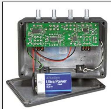
Der OTA-Overdrive ist ein Effektgerät für Gitarren, das die Eigenschaften gepaarter Silizium- und Germaniumdioden nutzt. Gesteuert von so genannten OTAs (Transkonduktanzverstärkern) entstehen Klangeffekte mit charakteristischen Färbungen.
