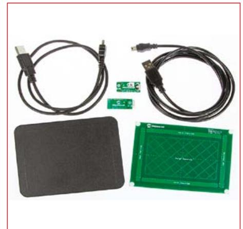
Dieses Vorteilspaket besteht aus dem Hillstar Development Kit MGC3130 und einem 3D-TouchPad von Microchip. Im Kit enthalten sind das Modul MGC3130, ein I<sup>2</sup>C/USB-Modul, eine vierlagige Referenzelektrode (aktive Fläche 95 x 60 mm), ein „Hand Brick“ (Bausatz aus vier Schaumblöcken und einer Kupferfolie) sowie ein USB-Kabel für den Anschluss an einen PC. Das Kit erlaubt die Parametrisierung des MGC3130 und der damit verbundenen Gestentechnik.
