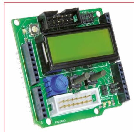
Da der günstige und einsteigerfreundliche Arduino Uno leider so gut wie keine Peripherie mitbringt, wurde dieses kompakte Shield entwickelt, das Anfängern mit einem Text-Display, LEDs und Tastern eine gute Basis für erste Schritte bietet. Über zwei weitere Erweiterungssteckverbinder lassen sich Relais-, Funk- und viele weitere Module anschließen.
