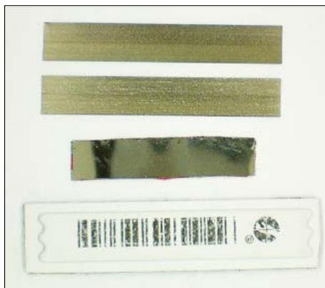
Bild 1. Ein AM-Etikett und sein Innenleben mit zwei Resonatoren und einem (kürzeren) Magnetstreifen.
