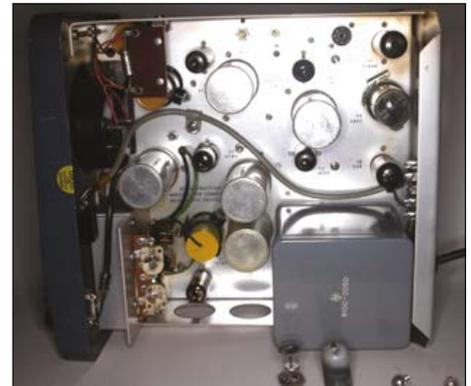
Bild 5. Gereinigtes Chassis mit an der Basis abgebrochener V9.
