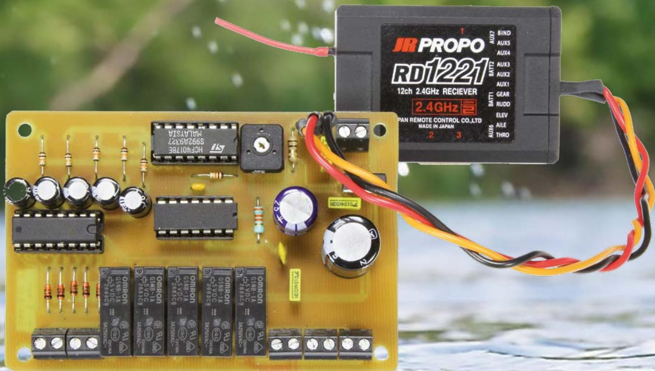
spricht der Mittelstellung. Mit dem Steuerhebel am Sender wird die Impulsbreite des Signals variiert.
