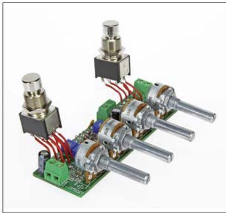
Bild 3. Das Foto zeigt einen Prototyp, hier sind die Fußschalter über Leitungen angeschlossen.
