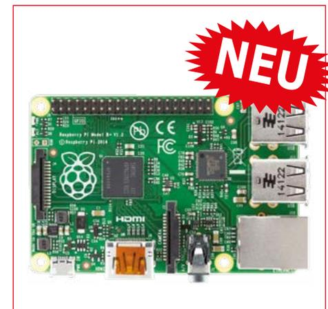
Die kleinste und billigste Version des sehr erfolgreichen Einplatinenrechners Raspberry Pi wurde komplett überarbeitet. Die neue Version mit dem Zusatz „+“ zeichnet sich durch geringeren Stromverbrauch, bessere Tonqualität, mehr GPIO-Pins und zusätzliche USB-Anschlüsse aus. Die Gesamtgröße der Platine ist ebenfalls geschrumpft.
