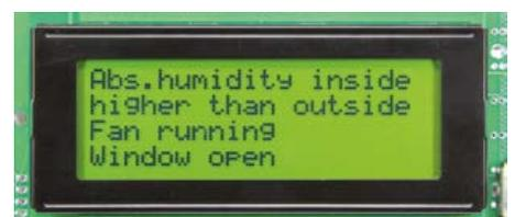
Bild 4. Werte und Meldungen, die auf dem LC-Display ausgegeben werden.
