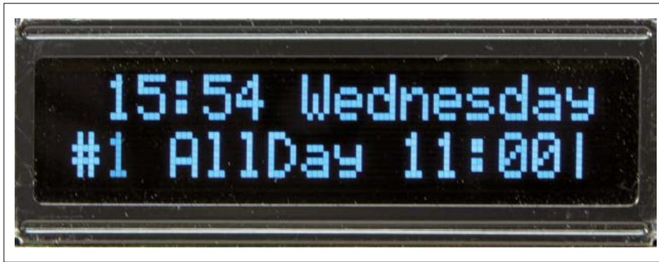
Bild 2. Nach Drücken des Tasters S1 erscheint in der unteren Display-Zeile das Alarm-Menü.
