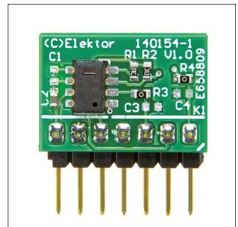
Bild 1. Die Adapterplatine erleichtert den Umgang mit dem ChipCap2-Sensor.
