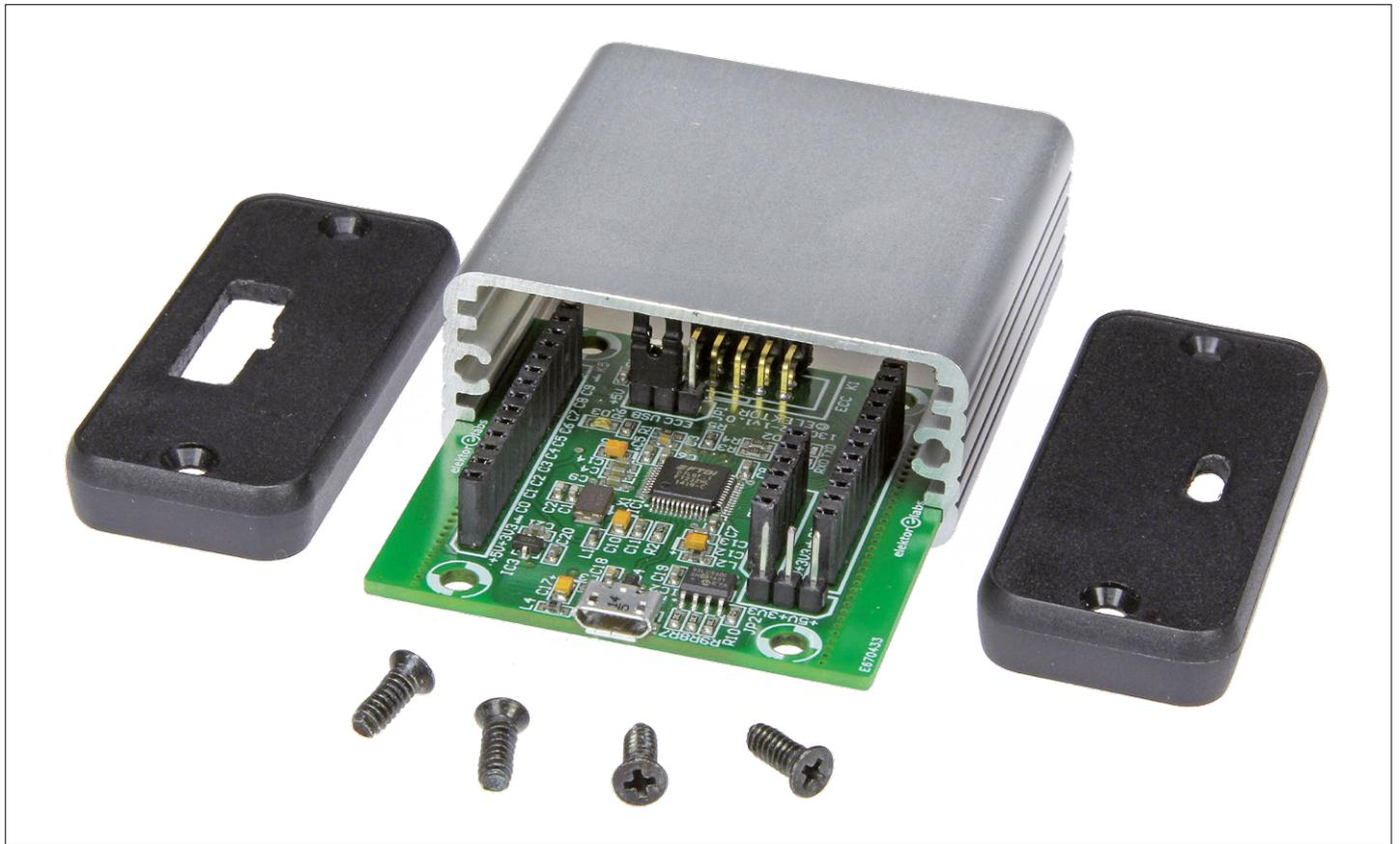
Bild 6. Das FT232H-Board passt exakt in das Aluminium-Gehäuse von Hammond. K1 schaut auf der anderen Seite heraus.
