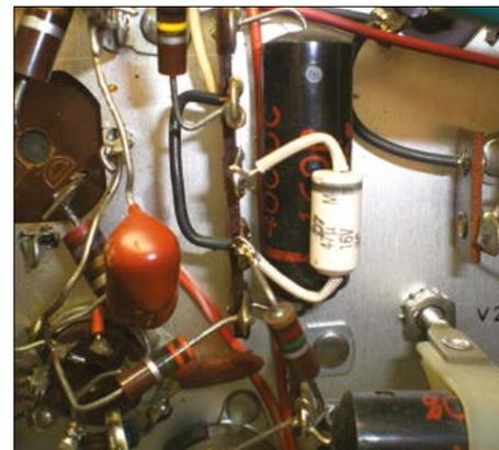
Bild 11. Der Ersatz für C107 wird über C23 eingebaut.
