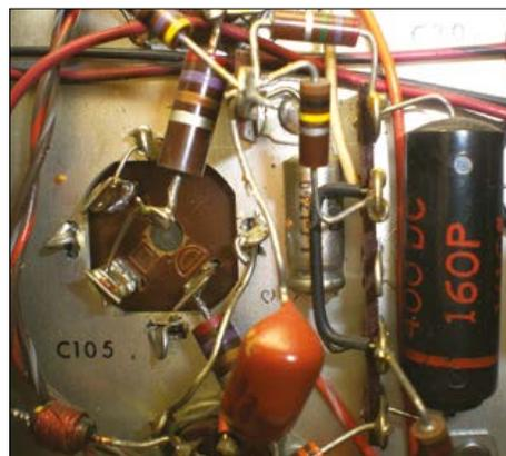
Bild 10. C107 (silbernes Gehäuse) unter anderen Bauteilen und einer schwarzen Drahtbrücke.
