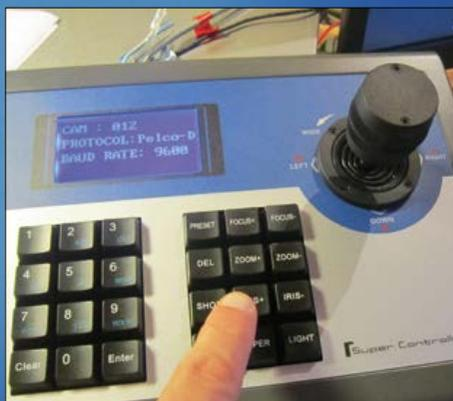
Bild 1. PTZ-Kameras werden meistens mit einer Tastatur und einem Joystick gesteuert.
