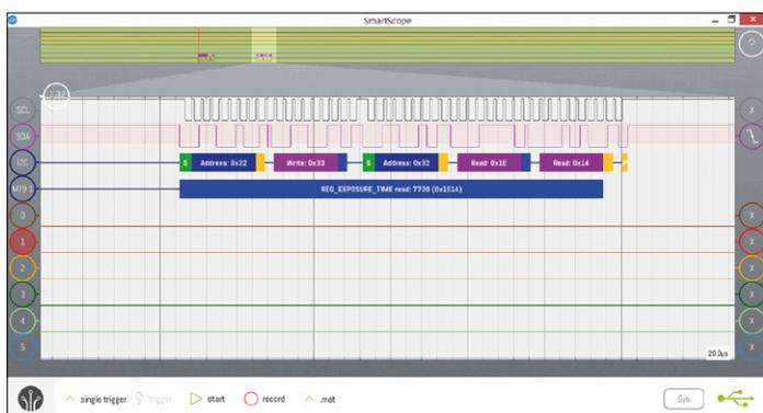
Bild 5. Die Signale eines I<sup>2</sup>C-Bus wurden zuerst vom eingebauten I<sup>2</sup>C-Decoder verarbeitet, anschließend hat sie ein zweiter Decoder in ein leicht lesbares Format umgesetzt.
