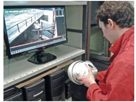
deosicherheitssystemen, wobei Theorie und Praxis Hand in Hand arbeiten. Zu Übungszwecken überwachen gegenwärtig 37 Kameras das Institutsgelände. Für die Planung und Ausführung wird die Software JVSG – CCTV eingesetzt, mit ihr kristallisieren die Studierenden die optimalen Kamerapositionen zum lückenlosen Erfassen des Areals heraus.
