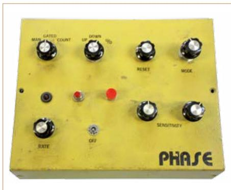
Bild 1. Das Bedienteil erlaubt die Konfiguration der Light-Show. Schmutz und Schrammen zeigen, dass die Anlage sehr häufig zum Einsatz kam. Der Aufdruck „PHASE“ rechts unten zeigt den Namen, unter dem wir damals lichtunterstützte Tanzmusik auflegten.
