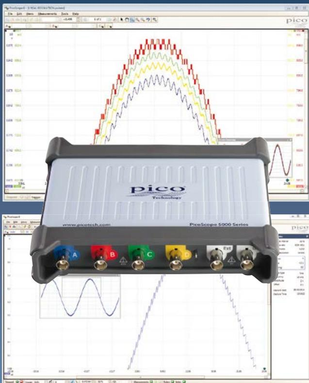
Die Oszilloskope der PicoScope 5000 Serie haben eine revolutionäre Hardware-Architektur, bei der viele hochauflösende AD-Wandler den Eingangskanälen in verschiedenen, zeit-interleaved und parallelen Kombinationen zugeteilt werden können. So wird entweder die Abtastrate auf bis zu 1 GS/s bei 8 bit oder die Auflösung bis 16 bits bei 62,5 MS/s gesteigert.
