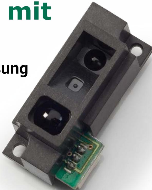
aber ein Objekt in den sensiblen Bereich des Sensors kommt, wird es einen Teil des ausgesendeten Lichts zum Fotodetektor reflektieren, worüber seine Präsenz registriert wird.
