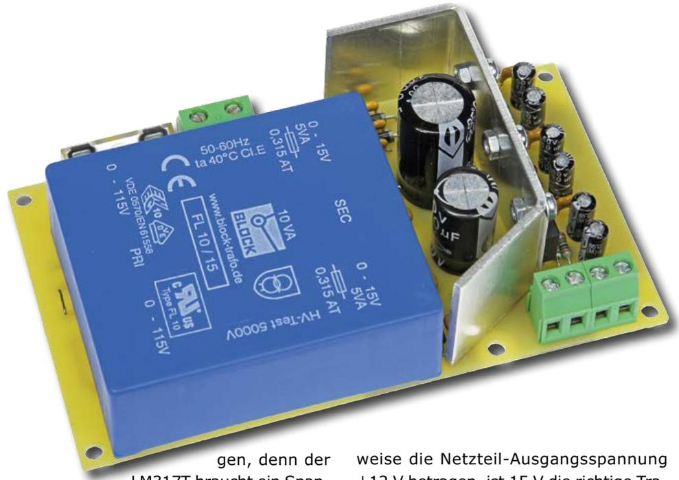
gen, denn der LM317T braucht ein Spannungsgefälle von mindestens 3 V. Hinzu kommen der Spannungsabfall an den Dioden sowie die Welligkeit der gleichgerichteten Spannung. Soll beispiels-
