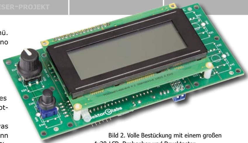
Bild 2. Volle Bestückung mit einem großen 4x20-LCD, Drehgeber und Drucktaster.
