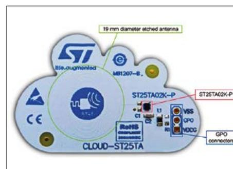
Bild 2. Für Experimente und Entwicklungen: das CLOUD-ST25TA-Eval-Board.
