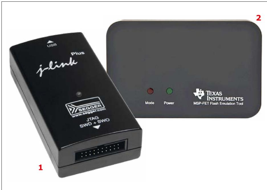
Bild 1. J-Link von Segger für ARM-MCUs [1] und MSP-FET [2] für die MSP430-Chips (Bilder: Segger/Texas Instruments).
