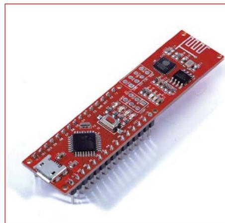
Das IoT WiFi Board ist ein einfach zu bedienendes und frei programmierbares Entwicklungsboard für das Internet of Things. Über einfache AT-Kommandos können Sie z.B. einen Webserver starten, das Modul als Access Point einstellen oder die Verbindung zu Ihrem Heimnetzwerk aufbauen.
