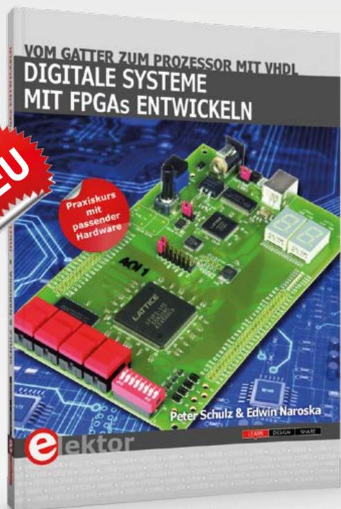
FPGAs sind Standard-ICs, die dem Anwender die Konfiguration von Hardwarestrukturen ermöglichen. Mit FPGAs ist die Umsetzung digitaler Systeme ab Stückzahl eins machbar. Durch die Verfügbarkeit kostenloser Lizenzen und preiswerter Entwicklungsboards ist die finanzielle Einstiegsschwelle in diese Technik niedrig. Bei der Überwindung der fachlichen Schwelle hilft dieser 6-teilige Kurs.
