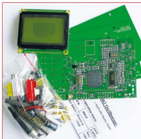
Dieses Kit ist ein einfach zu bauendes Oszilloskop. Es enthält alle benötigten Bauteile und Platinen, auf denen die SMDs bereits bestückt sind. Der Anwender muss nur noch die großen bedrahteten Bauteile platzieren und verlöten. Die gemessenen Wellenformen werden auf einem grafischen LCD mit 128 x 64 Pixeln wiedergegeben, das gemeinsam mit den Bedienelementen auf der Frontplatine sitzt.
