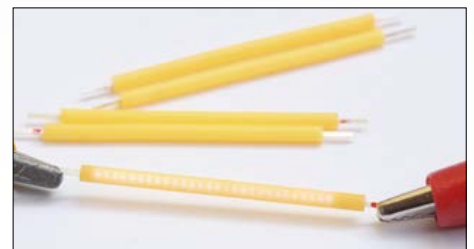
Bild 3. Wenn der Strom sehr stark begrenzt wird, kann man die einzelnen LEDs auf dem Substrat sehen.
