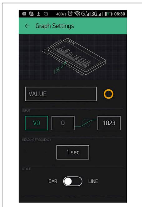
Bild 7. Aktualisierungsrate sowie Max- und Min-Werte wollen vorgegeben sein.
