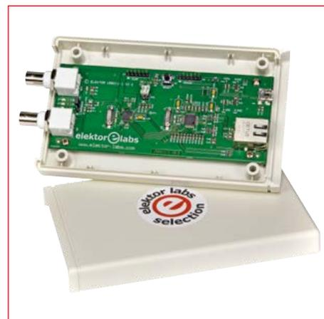
Wer gerne ein Oszilloskop, einen einfachen Signalgenerator und einen Spektrum-Analyser in seinem Elektronik-Labor haben möchte, der wird mit diesem preiswerten NCSA (Network Connected Signal Analyzer) Freude haben. Ein einfach bedienbares PC-Programm mit grafischer Benutzeroberfläche und ein Frontend mit dsPIC33 spielen bei diesem Projekt gewinnbringend zusammen.
