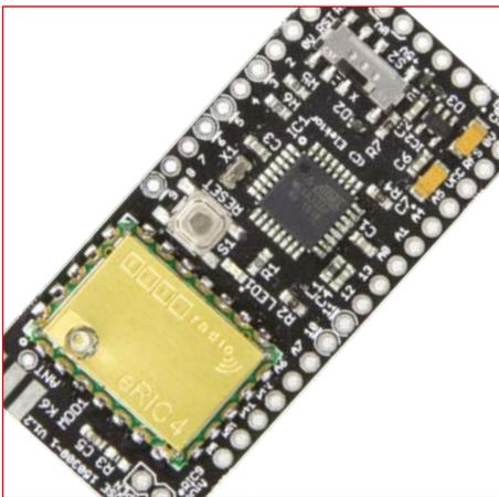
eRIC Nitro ist ein kleines (2,5 x 5,5 cm) Arduino-kompatibles Modul mit einem On-Board low-power ISM-Band-Funkmodul. Das Funkmodul kann selbstständig arbeiten; es wird durch den Mikrocontroller mit Arduino-Bootloader oder via PC gesteuert. Zwei PIN-kompatible Varianten sind ebenfalls verfügbar: eRIC4 für 433 MHz und eRIC9 für 869/916 MHz.
