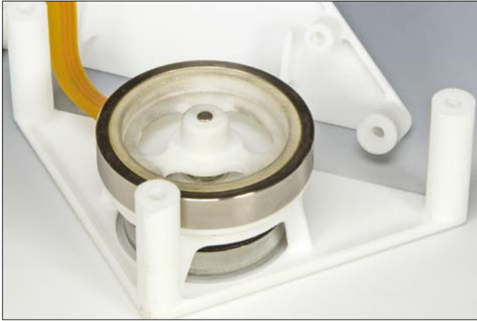
Bild 4. Der Motor mit montiertem Schwungrad und der zweiteilige Kunststoffrahmen.
