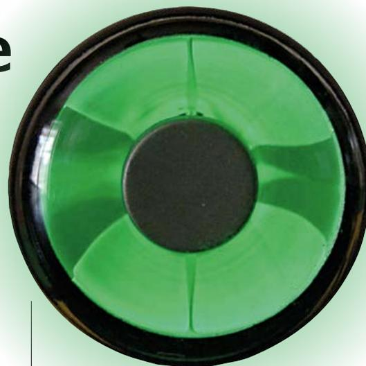
dem Target und viele Elektronen werden abgelenkt, was die leuchtende Fläche reduziert.
