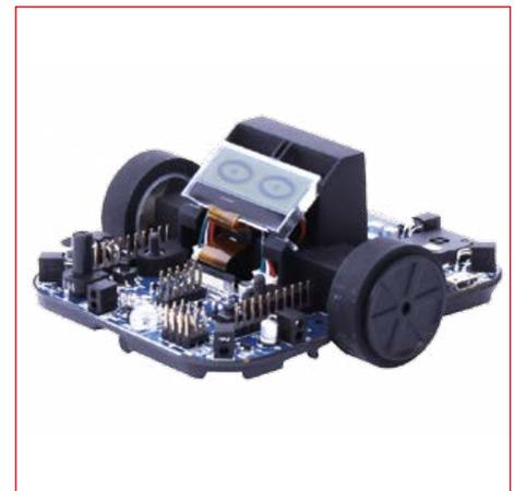
Formula AllCode ist ein kompletter Kurs zur Robotik mit eindrucksvollen Spezifikationen. Der Roboter selbst ist mit Bluetooth ausgestattet und kann so von der großen Rechenleistung externer Plattformen wie Android und Apples OS X/iOS oder auch Raspberry Pi und Arduino profitieren.
