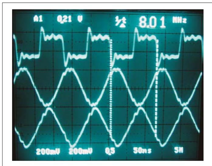
Bild 6. Das Oszilloskop zeigt, dass die Spannungen an den Quarz-Anschlüssen in Gegenphase sind (untere Kurven), die obere Kurve stellt die Oszillator-Ausgangsspannung dar.
