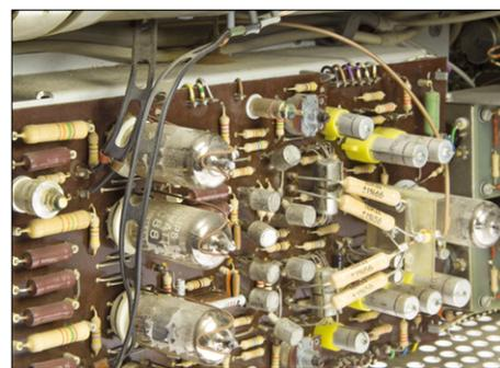
Bild 4. Symmetrisches Antennenkabel in einem Oszilloskop des Typs PM3110 von Philips. Es verbindet die Ablenkelektroden der Kathodenstrahlröhre mit dem Ausgang des Y-Verstärkers. Diese kurze Leitung überträgt bis zu 10 MHz bei 360 V<sub>y1-y2</sub> mit akzeptabler Kapazität.
