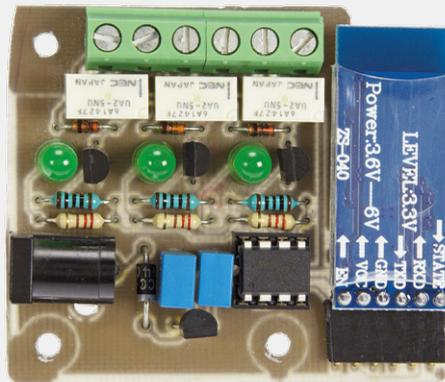
Bild 4. Das Bluetooth-Relais auf einer gelayouteten Platine (das Foto zeigt den Prototyp, der Bestückungsplan die endgültige Version). Die Platine ist nicht dazu geeignet, Netzspannung zu schalten!
