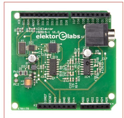
Dieser Arduino-Shield ist ein Remake des erfolgreichen SDR-Projekts aus dem Jahre 2007. Ein Software Defined Radio ist in der HF-Community ein populäres Allzweckwerkzeug, mit dem man auch sehr gut Messungen durchführen kann. Die Eigenschaften des Empfängers werden durch die Software definiert. Durch die Auslegung als Shield hat man nun die Möglichkeit, ein SDR mit Arduino zu betreiben.
