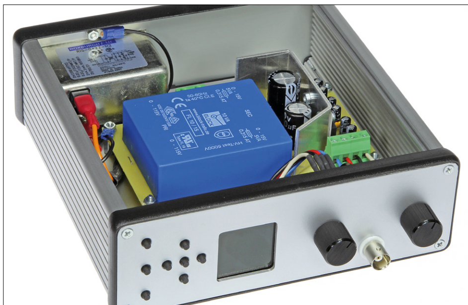
Bild 8. Der Prototyp, den Jan Visser im Elektor-Labor mit einer 100.000-Euro-CNC-Fräse Bohrmaschine, Laubsäge, Präzision und Geduld hergestellt hat.
