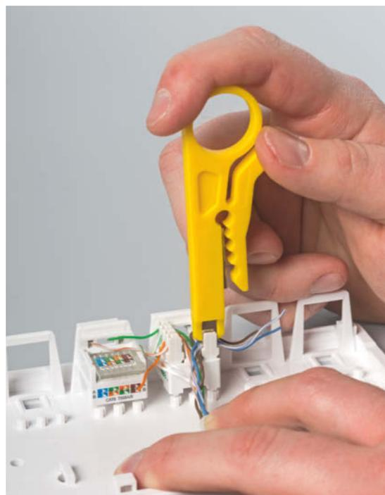
**Mit dem Auflegewerkzeug drückt man die Adern mit Fingerspitzengefühl in die Schneidklemmen. Der Jack links besitzt dafür eine eigene Presse. Farbkennungen an Netzwerkbauteilen erleichtern die korrekte Belegung.**
