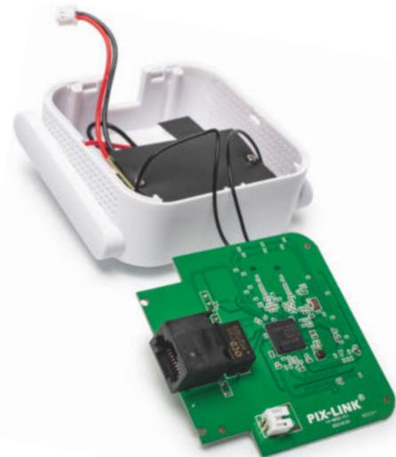
**Auf der UltraXtend-Platine sitzt ein Systemchip MT7628 von 2014, der nach dem alten WLAN-Standard IEEE 802.11n alias Wi-Fi 4 funkt. Aktuell ist Wi-Fi 6, akzeptabel noch Wi-Fi 5. Von einer angeblich verwendeten „Glasfaser-Technologie“ ist nichts zu sehen. Sie wäre im Repeater auch sinnlos.**
