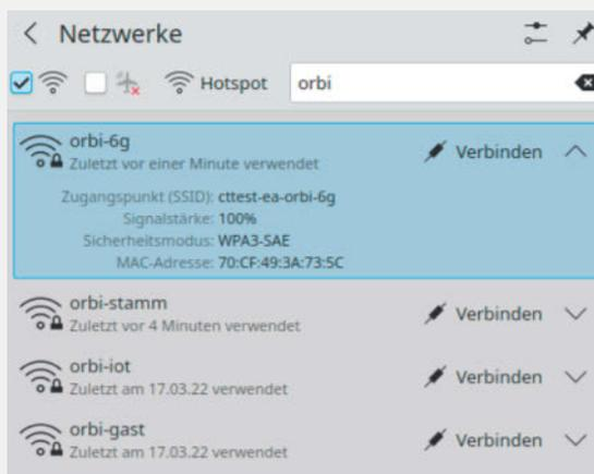
**Kubuntu 22.04 baut mit dem WLAN-Modul Intel AX210 Verbindungen über den Network Manager im 6-GHz-Band auf.**
