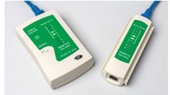
**Nahezu allen günstigen Netzwerksätzen liegt ein einfacher Durchgangsprüfer bei. Der aktive Teil (links) wird auf der einen Seite einer Kabelverbindung angeschlossen, der passive auf der anderen Seite. Blinkt Letzterer ununterbrochen und der Reihe nach von 1 bis 8 lückenlos durch, ist das Kabel korrekt aufgelegt.**
