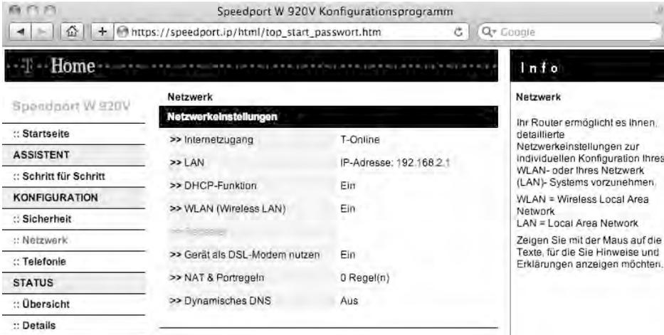
**Bild 2.21** Beim T-Home Speedport ist weit und breit keine Funktion zum Abschalten des TR-069-Protokolls zu sehen. Hier hilft nur der Umweg über eine selbst gebaute FRITZ!Box-Firmware.
