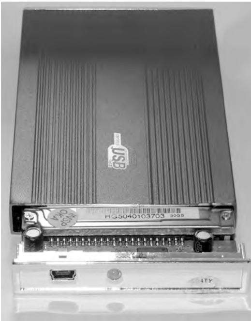
**Bild 6.8** Einstecken, einführen und verschrauben. Der Einbau einer Notebook-Festplatte in ein externes Gehäuse ist auch für Laien kein Problem.
