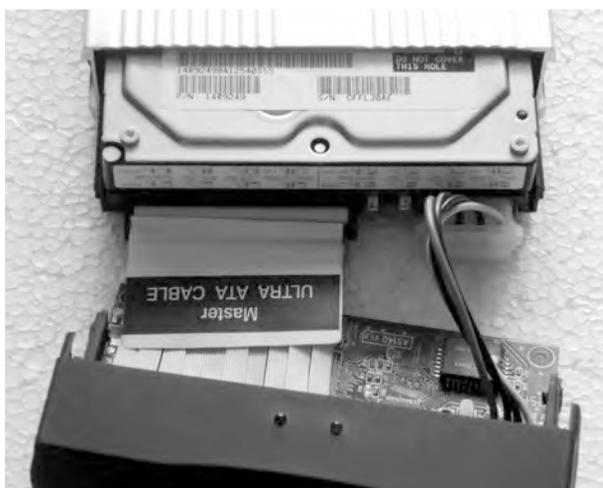
**Bild 6.4** Jumpers, zusammenstecken und vorsichtig in das Gehäuse einführen.
