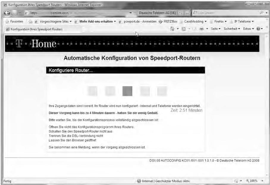
**Bild 4.8** Sind die Zugangsdaten geprüft, wird die Konfiguration auf den Router gesichert. Steht gegebenenfalls eine aktuellere Firmware zur Verfügung, wird auch diese übertragen und installiert.
