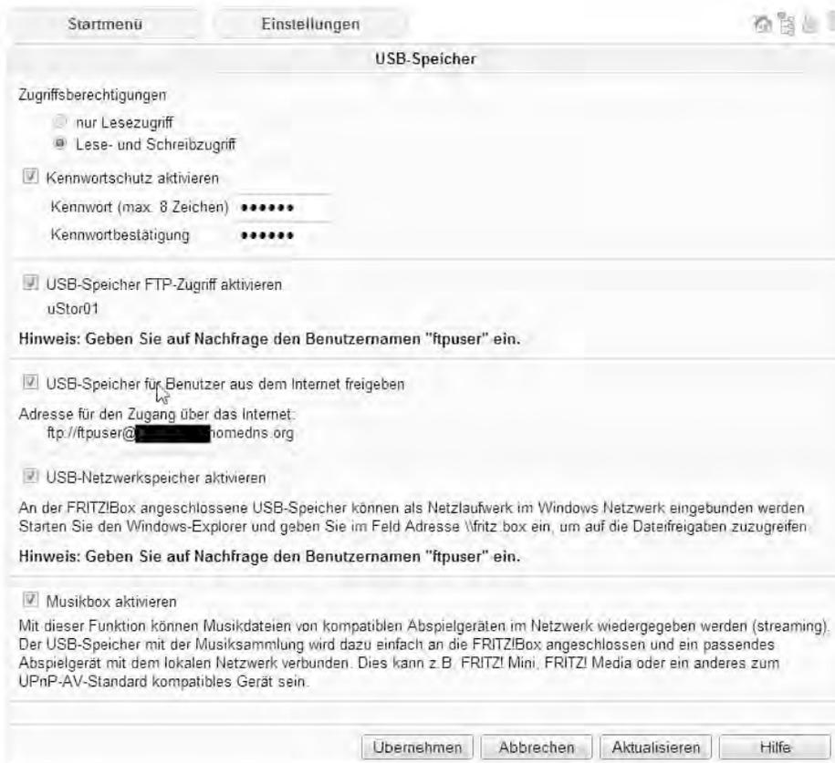
**Bild 6.50** Diese Häkchen sind zu setzen, falls der Inhalt der FRITZ!Box-Festplatte über das Internet zur Verfügung stehen soll.
