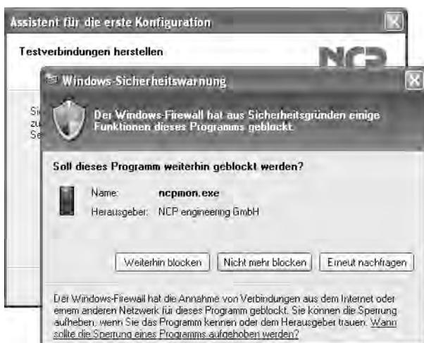
**Bild 8.23** Damit der VPN-Zugang auch funktionieren kann, darf die Firewall den NCP-Client selbstverständlich nicht blockieren.
