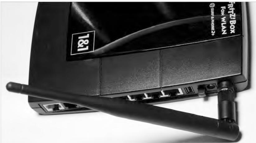
**Bild 3.8** Ist die neue Antenne auf der Buchse angeschraubt, können Sie die FRITZ!Box wieder in Betrieb nehmen.
