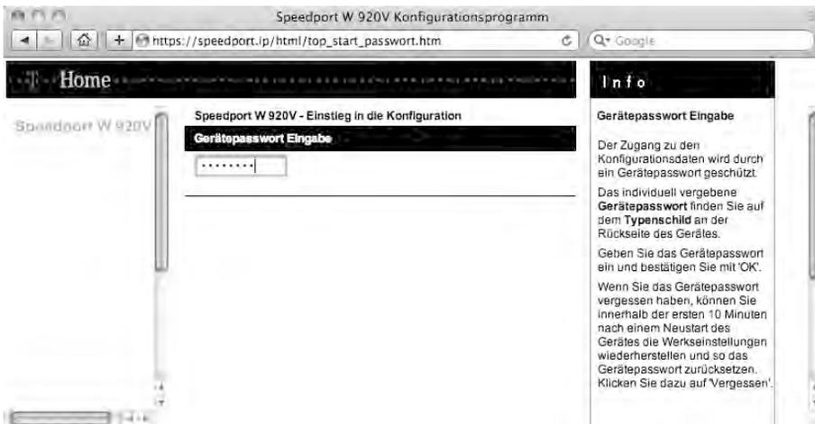
**Bild 4.12** Wer das Gerätepasswort vergessen hat, kann per Klick auf die Schaltfläche *Vergessen* den Speedport-Router auf die Werkeinstellungen zurücksetzen. In diesem Fall wird das Passwort auf den Wert zurückgesetzt, der auf dem Aufkleber auf der Rückseite des Speedport W 920V zu finden ist.
