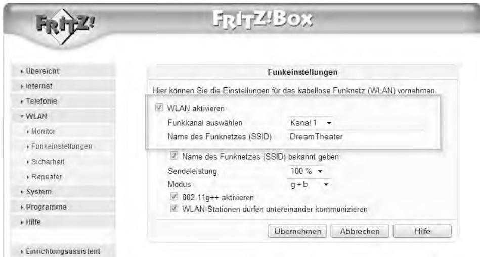
**Bild 2.9** Erst wenn das Häkchen bei *WLAN aktivieren* gesetzt ist, lässt sich der Name der SSID auf einen beliebigen Namen setzen.
