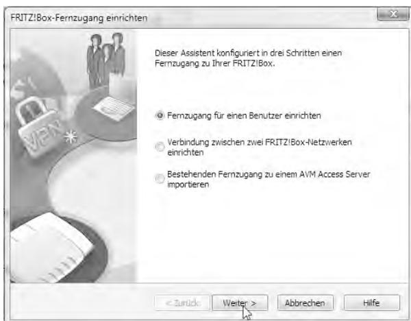
**Bild 8.9** Abhängig davon, welche Art der VPN-Verbindung erstellt werden soll, wählen Sie hier die entsprechende Option aus. Bei der Kopplung zweier Heimnetze ist die zweite Option die richtige – für den benutzerspezifischen VPN-Zugang zum Heimnetz ist *Fernzugang für einen Benutzer einrichten* auszuwählen.
