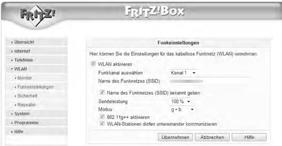
**Bild 2.36** Abhängig von den verwendeten WLAN-Komponenten, konfigurieren Sie den Übertragungsmodus.
