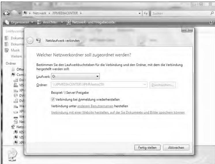
**Bild 9.9** Versteckter Link für anderen Benutzernamen: Abhängig vom verwendeten Benutzer sind unter Umständen zusätzlich eine Benutzerkennung sowie ein Passwort notwendig, um auf die Freigabe zugreifen zu können.
