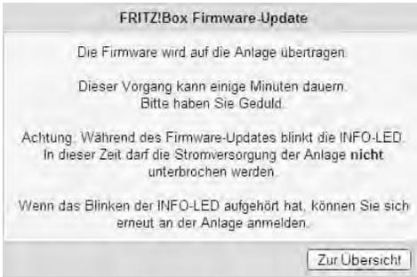
**Bild 2.31 Bitte warten: Während der Übertragung der Firmware auf den Router darf die Stromversorgung nicht unterbrochen werden.**
