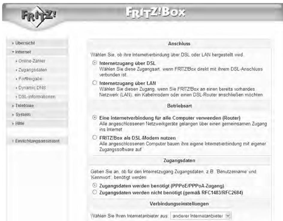
**Bild 2.43** Umständlich: Ist die FRITZ!Box nicht als Router, sondern »nur« als DSL-Modem konfiguriert, muss jeder Computer die Internetverbindung selbstständig herstellen.
