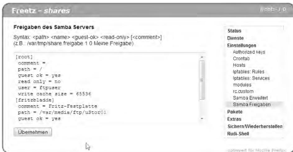
**Bild 6.46** Keine Tippfehler bitte! Da Freetz keinen *testparm*-Mechanismus zur Prüfung der *smb*-Parameter zur Verfügung stellt, funktioniert die Samba-Konfiguration – oder eben nicht.
