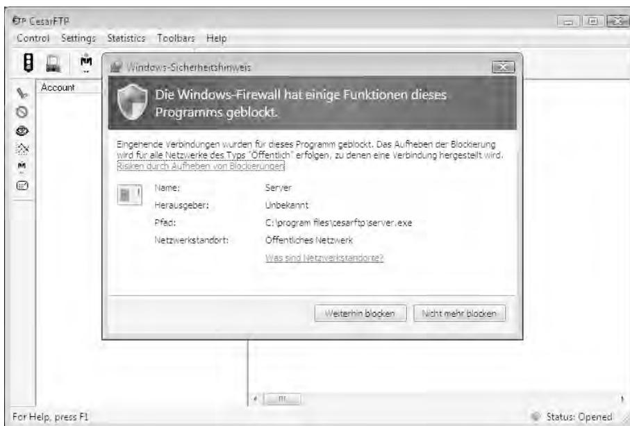
**Bild 7.11** Beim erstmaligen Start von CesarFTP schlägt die Windows-Firwall Alarm. Soll ein entfernter Rechner mit dem installierten FTP-Server Kontakt aufnehmen dürfen, klicken Sie die Schaltfläche *Nicht mehr blocken* an.
