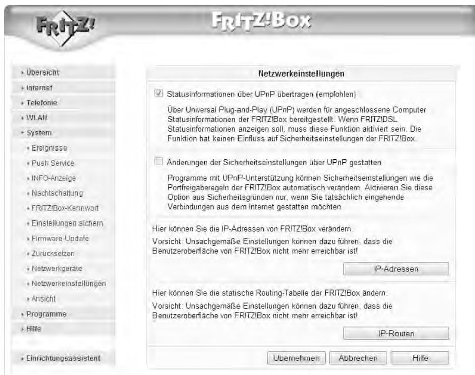
**Bild 2.48** Weniger ist mehr: UPnP wird in einem Heimnetz nicht gebraucht. Während die erste Option, *Statusinformationen über UPnP übertragen (empfohlen)*, keine Änderungen der Router-Konfiguration von außen zulässt, sollte bei der FRITZ!Box die Option *Änderungen der Sicherheitseinstellungen über UPnP gestatten* unbedingt deaktiviert sein.
