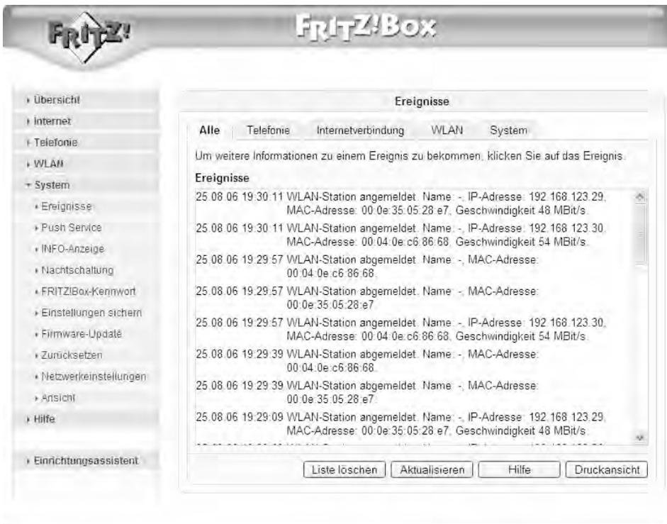
**Bild 2.38** Sämtliche An- und Abmeldevorgänge an der FRITZ!Box sowie die zugewiesenen IP-Adressen und dazugehörige Verbindungsgeschwindigkeiten werden in dem Protokoll erfasst.
