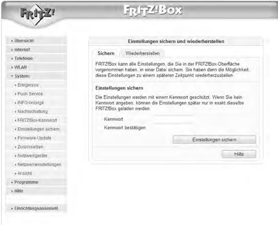
**Bild 2.25** Übersichtlich gelöst: Das Sichern und Wiederherstellen der FRITZ!Box-Konfiguration erfolgt in ein und demselben Dialog.
