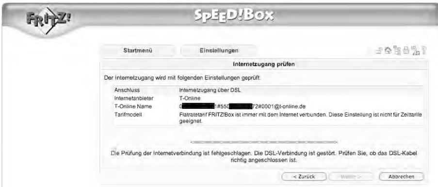
**Bild 5.19** Fehlersuche: Hier war das DSL-Kabel der SPEED-/FRITZ!Box nicht eingesteckt.
