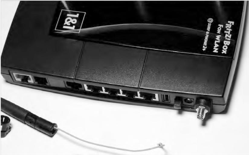
**Bild 3.7** Umbau erfolgreich: Ist das Gehäuse verschlossen, kann die neue Antenne angeschraubt werden.
