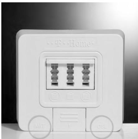
**Bild 4.3** Egal ob ADSL oder VDSL: Mit dem Splitter werden die Datenströme von den Telefonsignalen getrennt.
