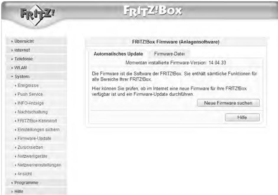
**Bild 2.28 Freie Auswahl:** Bei der FRITZ!Box können Sie die Firmware entweder über die AVM-Internetseite oder über eine Firmwaredatei, die sich auf der Festplatte befindet, aktualisieren.
