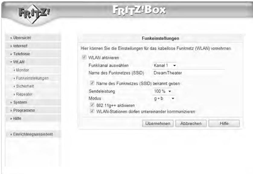
**Bild 1.4** Der schnelle 802.11g++-Modus funktioniert nur mit hauseigenen FRITZ!-Komponenten. Kommt es mit einem FRITZ!-AVM-Gerät zu Verbindungsproblemen, sollten Besitzer einer WLAN-FRITZ!Box diesen Schalter deaktivieren.
