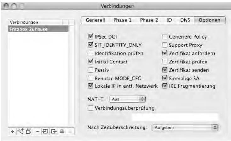
**Bild 8.40** Das A und O sind in diesem Dialog die beiden Häkchen bei *IPSec DOI* und *Lokale IP in entf. Netzwerk*.
