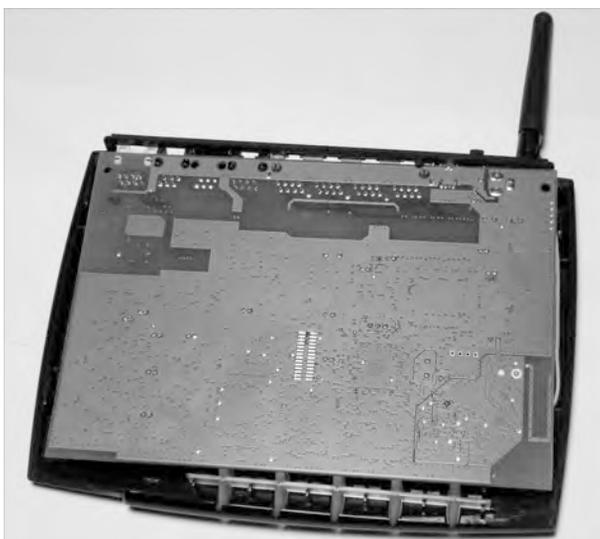
**Bild 3.4** Nun lässt sich der Boden des Gehäuses abnehmen – die Platinunterseite der FRITZ!Box ist zu sehen.
