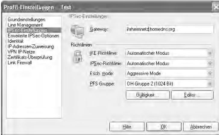
**Bild 8.25** Klappt der Verbindungsaufbau nicht, hilft das Umschalten vom automatischen Modus in den manuellen. Hier ist anschließend die Schlüssellänge genau anzugeben.
