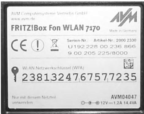
**Bild 2.11** Neuere FRITZ!Box-Modelle sind ab Werk schon mit einem sicheren WPA2-Schlüssel vorkonfiguriert. Dieser befindet sich auf der Bodenplatte des Geräts.
