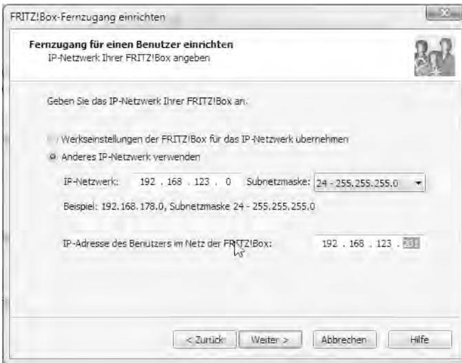
**Bild 8.12** Nach dem Klick auf die *Weiter*-Schaltfläche erzeugt der Assistent die Konfigurationsdatei für die FRITZ!Box.
