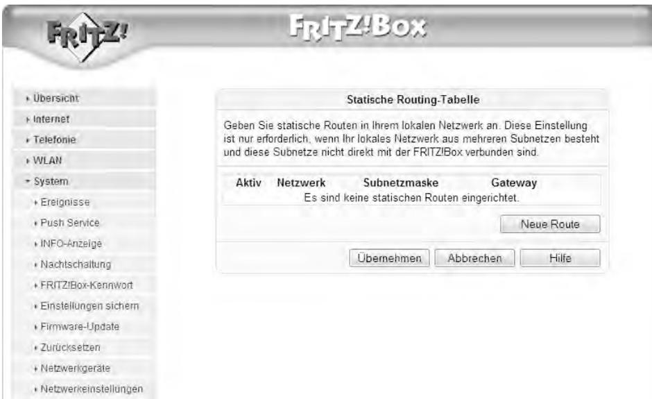
**Bild 2.46** Nach einem Klick auf *Neue Route* haben Sie mit der FRITZ!Box die Möglichkeit, die Netzwerkparameter des anderen Routers einzutragen. Anschließend ist der Zugriff in beide Richtungen möglich.
