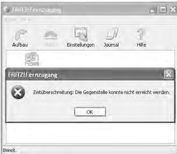
**Bild 8.20** Damit eine VPN-Verbindung zur Heimnetz-FRITZ!Box aufgebaut werden kann, muss diese auch über ihren dynamischen DNS-Namen im Internet ansprechbar sein. Ist das nicht der Fall, erscheint diese Fehlermeldung.
