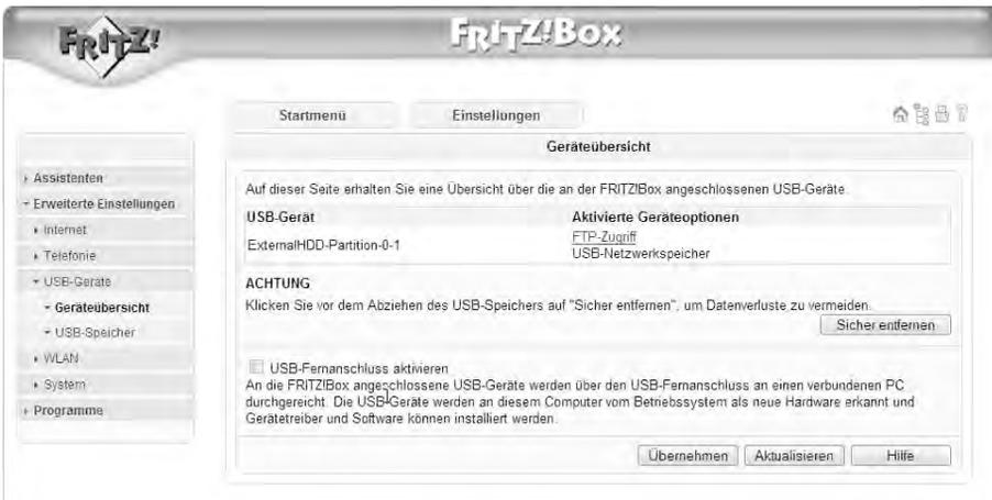
**Bild 6.17** Zunächst wird die USB-Festplatte mit der Bezeichnung *ExternalHDD-Partition-0-1* erkannt – abhängig von der installierten Firmware und dem FRITZ!Box-Modell kann diese Bezeichnung jedoch abweichen.
