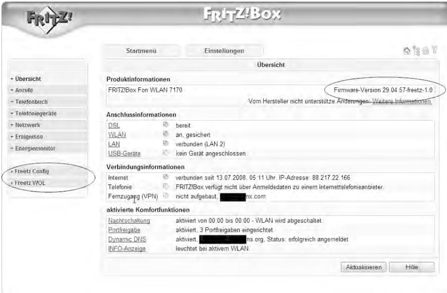
**Bild 6.42** Firmware-Update erfolgreich: Die selbst gebaute Firmware ist nun auf der FRITZ!Box aktiv.
