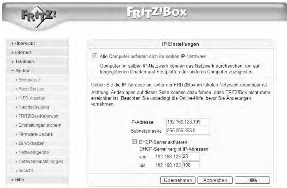
**Bild 2.45** Bei der FRITZ!Box ist der DHCP-Server ab Werk bereits aktiviert. Die entsprechende Konfigurationsseite ist über *Menü/Einstellungen/System/Netzwerkeinstellungen* per Klick auf die Schaltfläche *IP-Adressen* zu erreichen, falls zuvor über *Menü/Einstellungen/System/Ansicht* die Expertenansicht aktiviert wurde.
