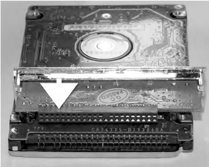
**Bild 6.6** Der Steckpfosten des USB-Gehäuses ist verpolungssicher ausgeführt.
