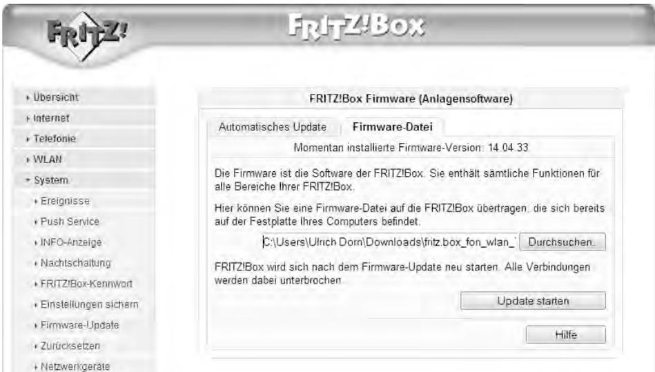
**Bild 2.30** Entweder via Internet oder über eine Firmwaredatei: Eine frische Firmware sorgt für Sicherheit.
