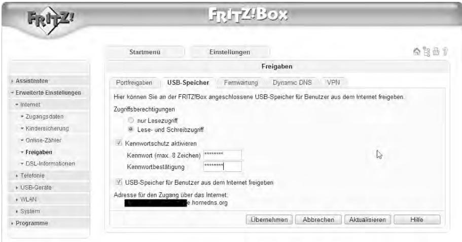
**Bild 6.19** Für den Zugriff aus dem Internet ist eine eingerichtete dynamische Adresse bei *dyn dns.org* oder bei alternativen Anbietern notwendig, was im Register *Dynamic DNS* erledigt wird.
