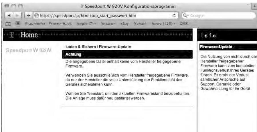
**Bild 5.13** Hier erscheint eine Warnung, die darauf hinweist, dass die Firmware keine »Original-Firmware« der Telekom ist – klicken Sie NICHT auf *Neustart*, sondern warten Sie so lange, bis der Speedport einen automatischen Neustart einleitet.
