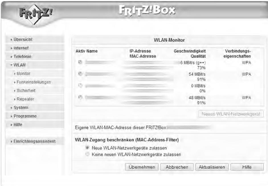
**Bild 2.20** Standardmäßig erhält jede WLAN-Karte, die mit einer passenden SSID konfiguriert ist, Zugriff auf das drahtlose Netzwerk. Für mehr Sicherheit bei der FRITZ!Box sorgt dieser Dialog: Hier können Sie den Zugang auf das WLAN auf Grundlage einer MAC-Adresse beschränken.
