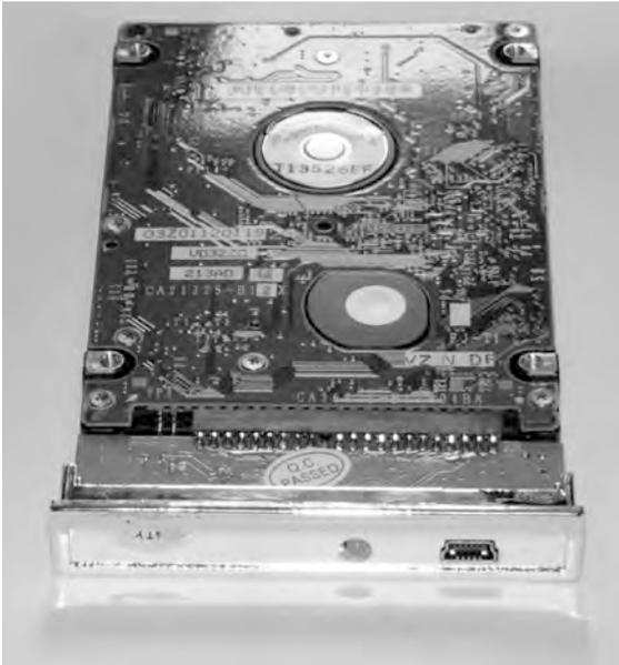
**Bild 6.7** Einfach zusammenstecken: Achten Sie darauf, dass die Steckverbindung einwandfrei und gerade mit der Festplatte verbunden ist.
