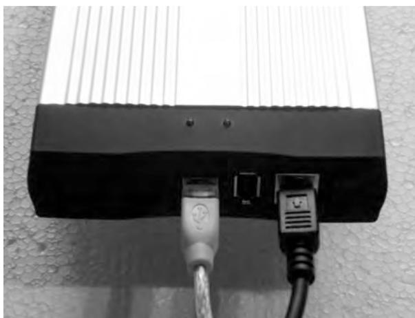
**Bild 6.5** Installation erfolgreich: Nach dem USB-Datenkabel ist das Stromkabel anzuschließen.
