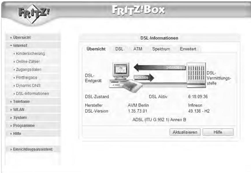
**Bild 8.3** Jeder DSL-Router zeigt die Verbindungsdaten und die Geschwindigkeit zur Vermittlungsstelle in seinem Konfigurationsmenü an.
