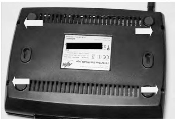
**Bild 3.3** An diesen vier Stellen drücken Sie mit einem flachen Schraubendreher sanft die Plastiklaschen ein, damit sich das Gehäuse der FRITZ!Box öffnen lässt.
