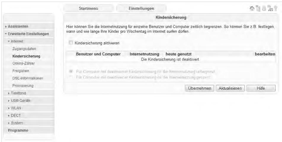
**Bild 2.49** Wenn Sie die Kindersicherung nicht benötigen, achten Sie darauf, dass sie auch ausgeschaltet ist. Andernfalls sorgt die Kindersicherung auf Port 14013 für überflüssige Kommunikation im Heimnetzwerk.
