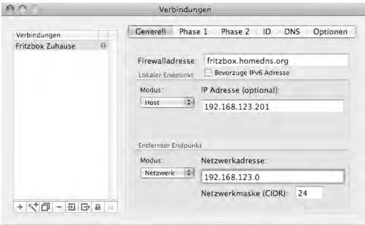
**Bild 8.35** Zunächst klicken Sie links im unteren Bereich auf das Plusymbol und tragen einen aussagekräftigen Namen für die VPN-Verbindung ein.
