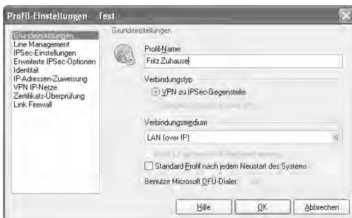
**Bild 8.24** Zunächst tragen Sie im Bereich *Grundeinstellungen* eine aussagekräftige Bezeichnung für die Verbindung in das Heimnetz ein.
