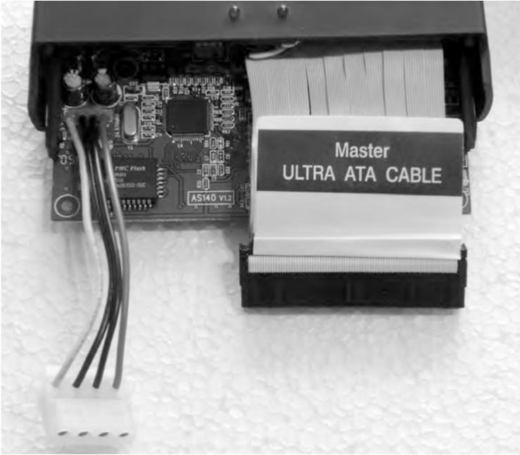
**Bild 6.3** Gewohnte Anschlüsse: links die Stromversorgung, rechts das Datenkabel zum Anschluss der Festplatte.
