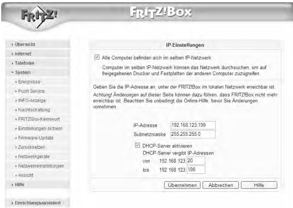
**Bild 2.44** Ist das Häkchen bei *Alle Computer befinden sich im selben IP-Netzwerk* gesetzt, ist der Zugriff der Computer untereinander auf die freigegebenen Drucker und Daten der Arbeitsgruppe gewährleistet.
