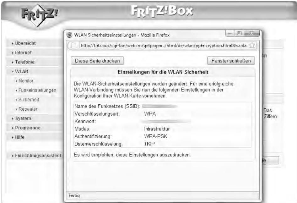
**Bild 2.12** Die FRITZ!Box unterstützt mit WPA2 die derzeit aktuellste Verschlüsselung für WLANs. Lässt sich WPA2 bei der FRITZ!Box nicht auswählen, hilft ein Firmware-Update, um die Box auf den aktuellen Stand zu bringen.
