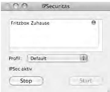
**Bild 8.42** Im Verbindungsfenster weist IPSecuritas mit *IPSec aktiv* und einem grünen Lämpchen auf eine aktive Verbindung hin.
