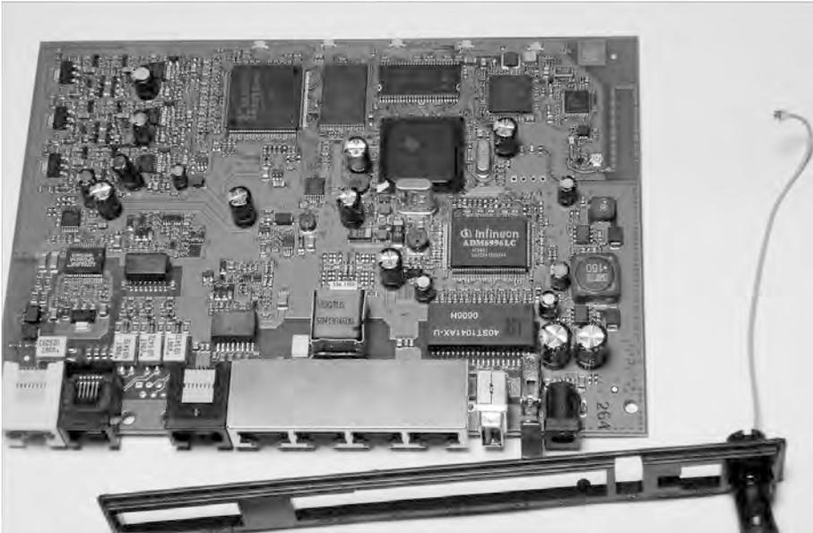
**Bild 3.6** Haben Sie das Kabel der alten Antenne von der Platine abgezogen, demontieren Sie die Antenne von der Plastikabdeckung.
