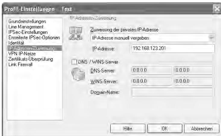
**Bild 8.28** Hier tragen Sie die IP-Adresse ein, die für den Fernzugriff »zugelassen« ist und dem PC nach *Verbindungsaufbau* zugeordnet werden soll.
