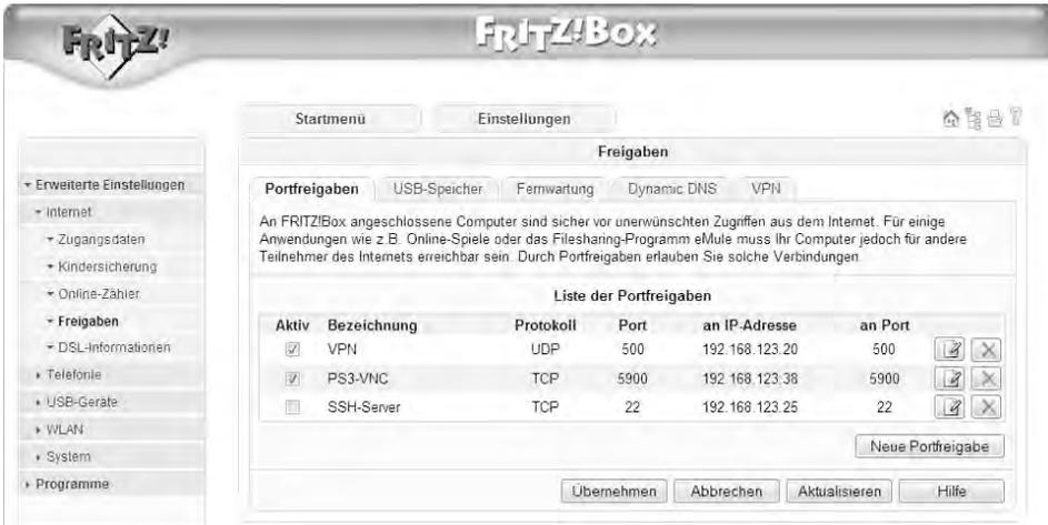
**Bild 2.15** Per Klick auf die Schaltfläche *Neue Portfreigabe* richten Sie eine neue Verbindung von außen auf einem PC im Netzwerk ein.
